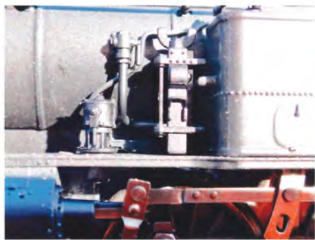
Der er ikke mange armaturer på kedlen - denne står foran vandkassen.
