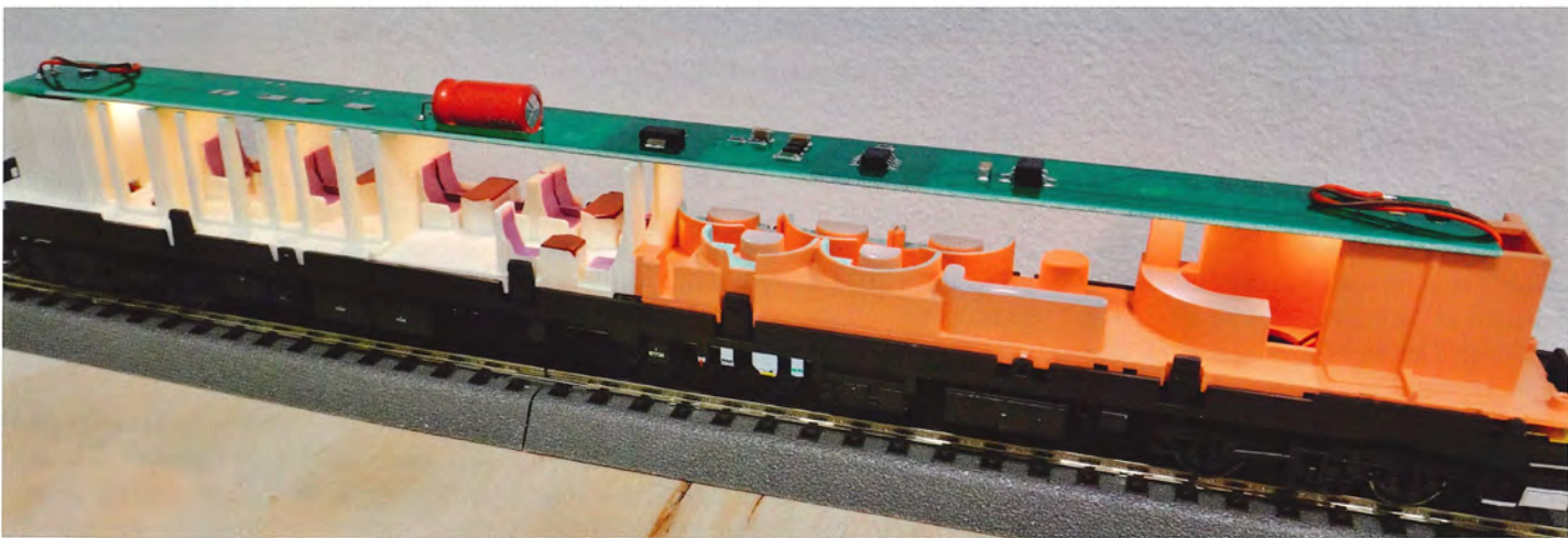
Indretningen i bistrovognen er meget broget og blandet. På platinet ses den store buffer-kondensator.
