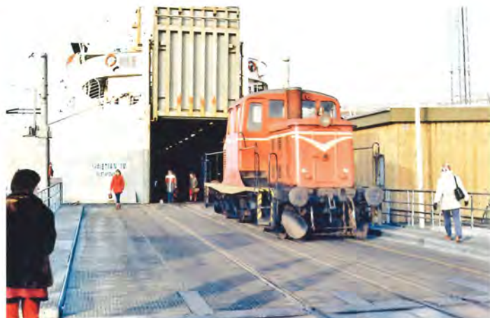
Diesellokomotiv HP 14 (Frichs 1953, tidl. TFJ, tidl. HV) rangerer på klappen til M/F "Christian IV" efter ombygningen i 1982 af leje og færgeklapp til de nye, brede bilfærger. "Christian IV" blev solgt i 1984. Herefter var der kun én jernbanefærg på ruten i resten af dens tid. (Foto: Jørgen Knudsen 1983)
