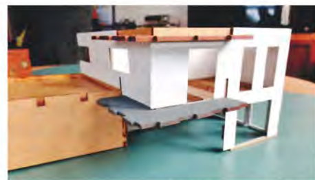
Såvel inder- som ydersider er beklædt med polyplate-materialet, et let nobret materiale.
