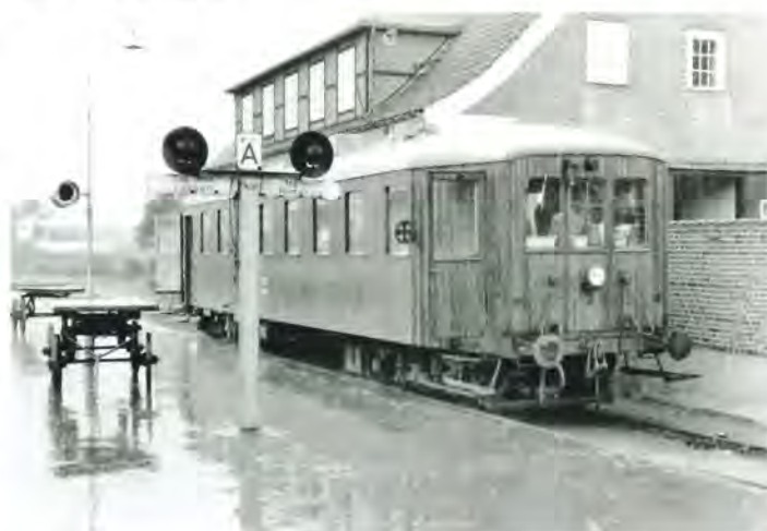
De motorvogne, banerne anskaffede i midten af 1920'erne, M 20-23, var langt mere driftsikre end ”spidsmusene”. M 20 (Scandia 1925), som ses her, var i fuldt vigør (om end den fik skiftet motor et par gange) helt frem til den blev udrangeret i 1971. (Foto: HGC)
