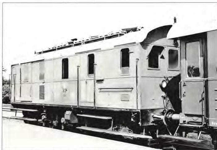
HP 11 (tidl. HH 14, Frichs 1932), et af de tre store 300 HK's diesellokomotiver, banerne anskaffede i begyndelsen af 1930'erne. De havde rejsegodsrum og var derfor længere end de "firkantede", Frichs senere leverede til andre privatbaner. (Foto: KEJ)
