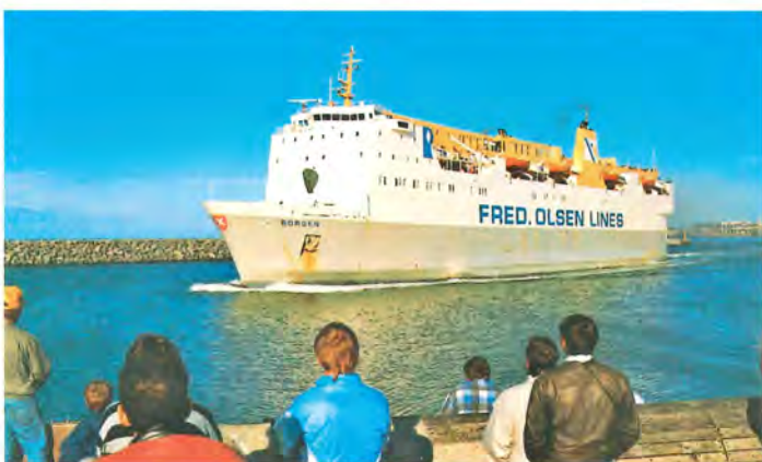
Den tre-sporede bil- og jernbanefærg M/F "Borgen" under udsejling fra Hirtshals. Indsat på H-K-ruten som nybygget i 1975. Sammenlignet med gamle "Skagen" (hvis navn den arvede ved rederiskiftet i 1990) er den ikke nogen skønhedsåbenbaring, og en ombygning i 1980'erne med bl.a. et ekstra bildæk gjorde den endnu mere klodset og uharmonisk. Den skulle desværre blive sidste jernbanefærg på ruten. (Postkort fra 1980'erne, JCJ's samling).
