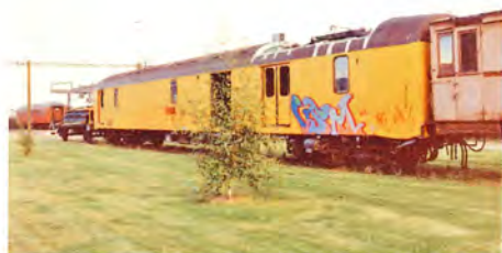
Målevogn 2 med pantograf, ombygget fra litra P. KH GB sommer 1998. Foto Flemming Søeborg.
