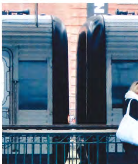
IC3-sammenkobling. På billedet til venstre ser man, hvordan bælgen er tømt for luft. På billedet yderst til højre er de to tog sammenkoblede, og bælgene fyldt med luft igen. Odense den 12. december 2023. Foto Flemming Søeborg.
