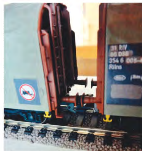
Relativt tæt kobling med Märklins kortkoblinger.
