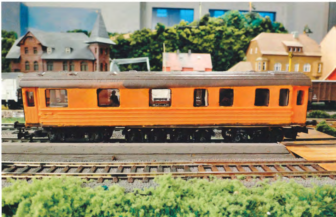
Mauzin-vognen i næsten færdig tilstand, omend LOK har nogle problemer med dens kørsel på anlægget - midterbogien har en masse små hjul, som giver problemer under kørslen.
