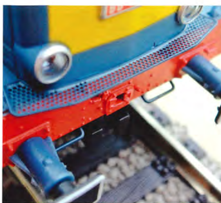
Fine detaljer såsom gennembrudt metalplade på fronten for rangerpersonalet.
