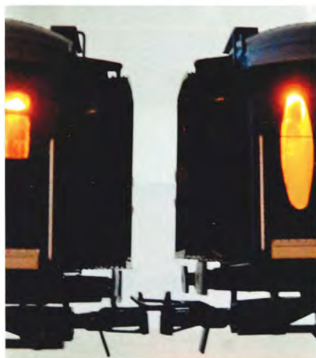
Koblingsafstanden med almindelige A-koblinger - men variabel pga. 'slug' og sløvhed i konstruktionen.
