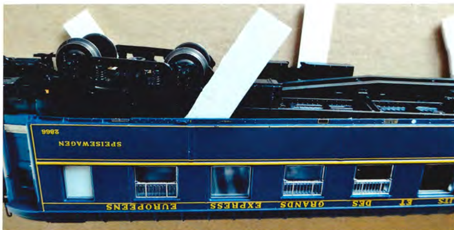
Med hjælp af små stykker hård plast kan overdelen fjernes.
