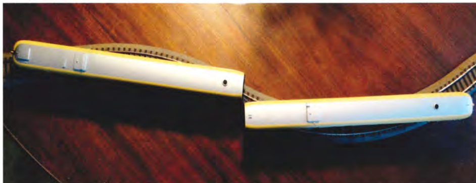
Toget kan sagtens køre i R 2-kurver - det ser bare sådan ud, når det skal gennem en S-kurve.
