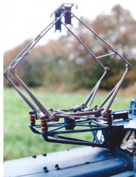
Pantograferne har deres helt speciellestativ hængt op på begge sider af førerhuset
