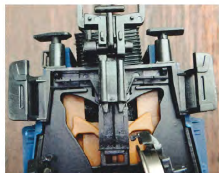
Lidt primitiv fjedermekanisme i hver vognende. Pufferhovederne falder nemt af.
