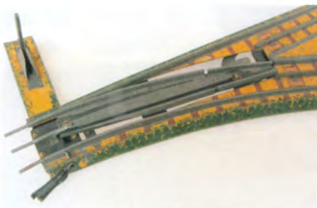
Sporskifte med plads til de store flanger.
