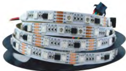
LED strimmel med indbyggede dekodere
