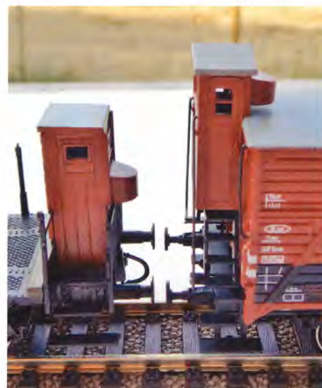
To typer af bremsehus -Märklins G 10 til højre.
