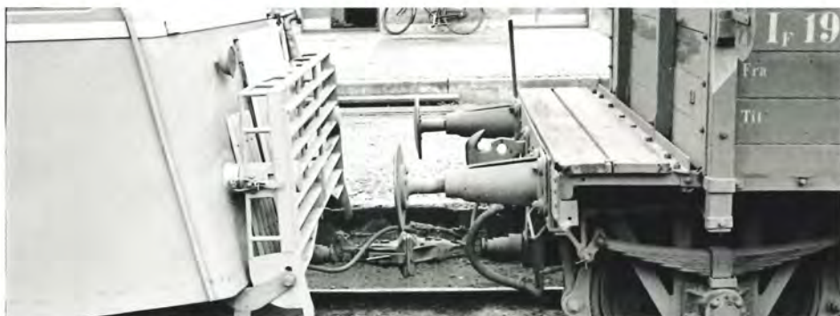
Skinnebussen Ms 30 er koblet sammen med en noget ukonventionel "bivogn" i form af en almindelig (om end kort!), lukket godsvogn, forsynet med en skinnebuskobling. Et lidt uharmonisk tog!
