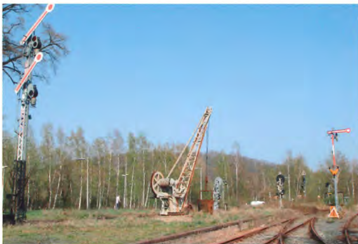
Forskellige signaler og andet udstyr - bemærk armsignalet med 'negative' farver (for bedre synlighed).
