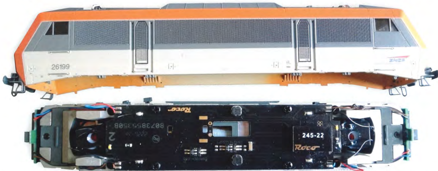
Det indre er lige så velorganiseret som det ydre - moderne modelkonstruktion. De små kontakter er til indstilling af lanterneerne.
