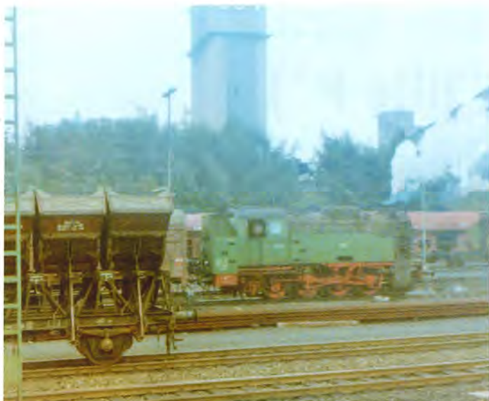
'Anna Nr. 7' under rangering ved kulværket i Alsdorf august 1982. Som det ses, er dette en maskine med sidevandtanke.
