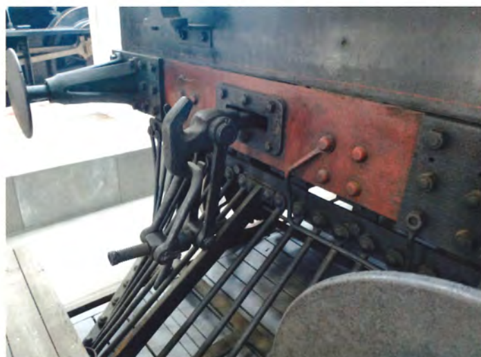
Kofanger og trækkrog på tenderens 'bagside' - som jo altså er forrest ved normal kørsel.
