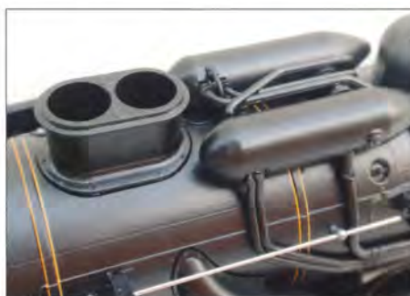
Den dobbelte skorsten og to forvarmere på kedelryggen.
