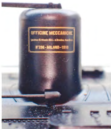
Fabrikspladen er monteret på domen.
