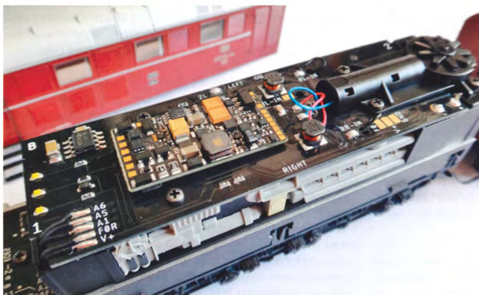
Platiner, dekoder m.v. i den ene lokomotivhalvdel. Endvidere ses motorattrappen nederst.
