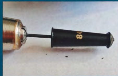
Skorstenen bores ud med 0,9 mm bor.
