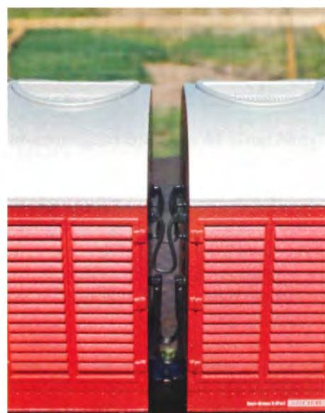
Meget tæt sammenkobling med frithængende kabler.
