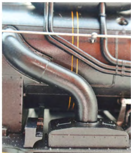
Nogle af de mægtige rør fra forvarmeren ned til cylindren.
