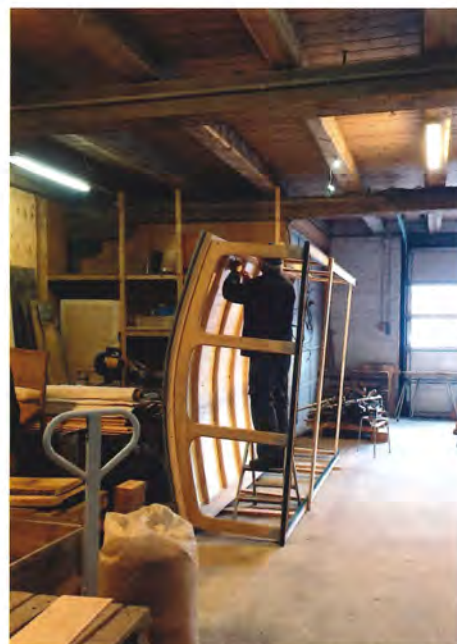
Taget fra FS 31 lakeres indvendigt for montering. Foto Jesper Reinfeldt.
