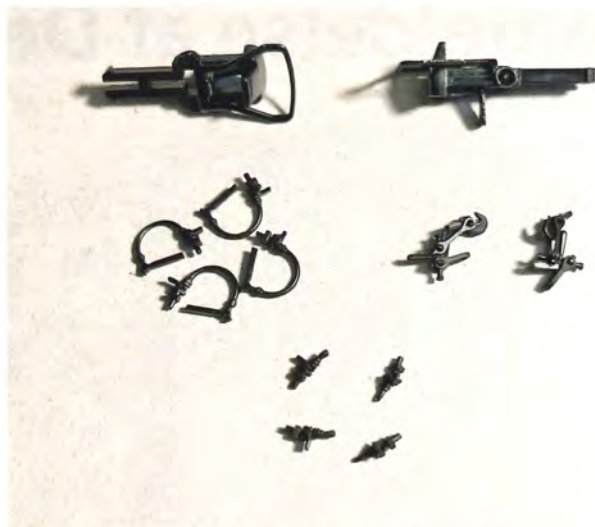
"Godteposen": God kvalitet A-koblinger, fine skruekoblinger, bremseslanger samt "bremseslanger uden slanger", som kan monteres sammen med virksom kobling.
