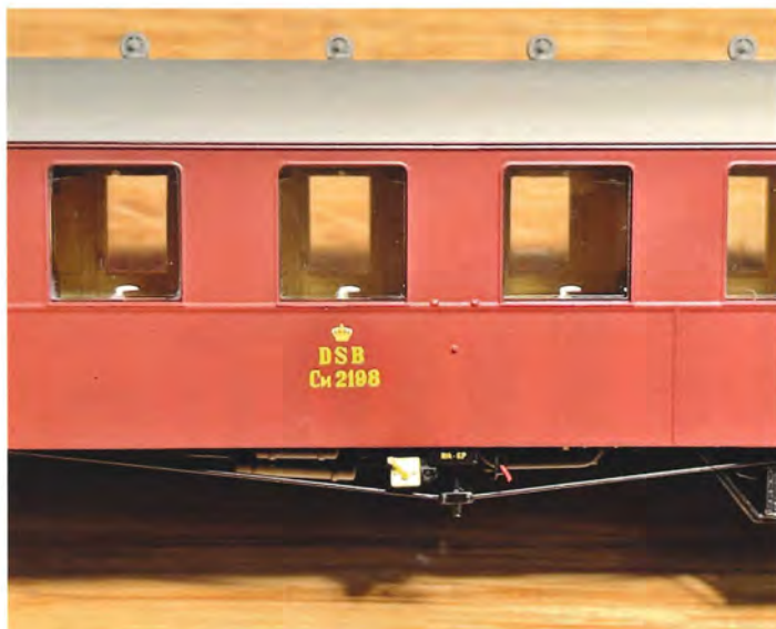
Fine påskrifter og bremseomstillere, i vinduerne ses varmereguleringshåndtagene.
