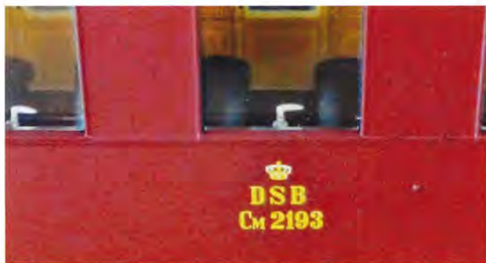
Vognside med litrering og et kig ind i en kupé. Håndtagene er til varmeregulering og har ikke noget med åbning af vinduerne at gøre.
