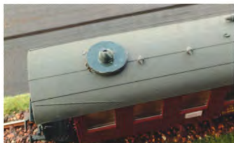
Skorstenen, fremstillet af en 'Anker Jørgensen' (lille fem-øre), en passende plastic-skive samt en stump rør.
