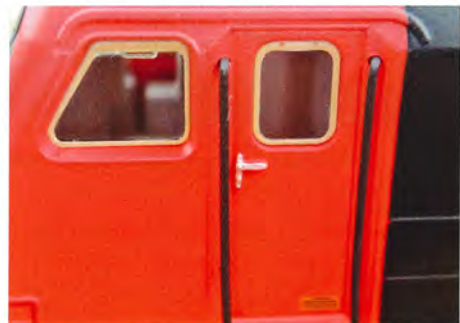
Sidedør med håndtag, regnlist og håndbøjler af tynd tråd.
