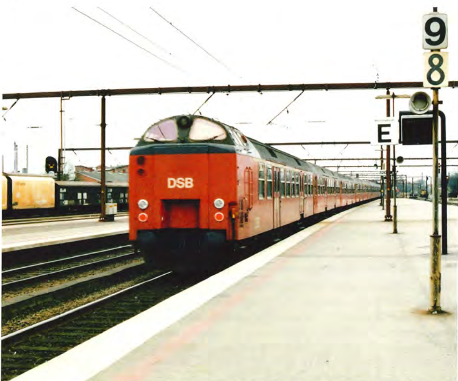
Bns-styrevogn med Re-tog i Odense april 1998. Her ses det tydeligt, hvordan fronten er afdækket med en plade. Foto Flemming Søeborg.
