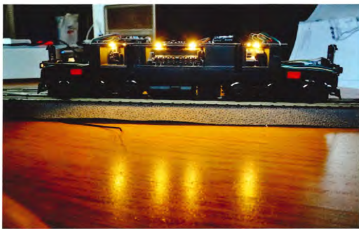
Modellen uden overdel, men med belysningen tændt i motorrummet.
