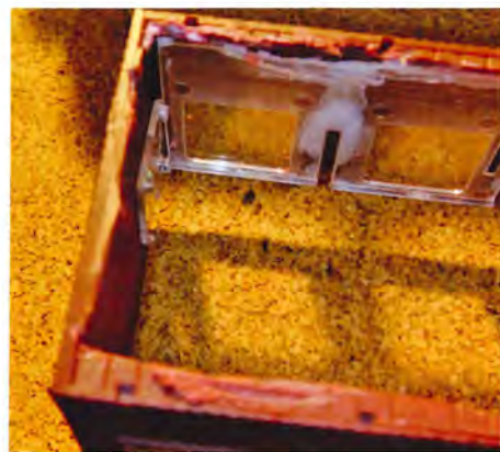
Her er bunden savet ud af rystevognens vognkasse - pas på ikke at ødelægge de store ruder.
