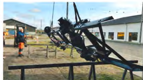
Her bliver chassiset til bus 37 anbragt på bukke forud for montering af køler og motor.
