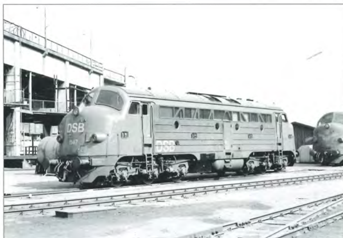
I 1974 havde My 1147 fået monteret den ekstra klap på fronten. Foto fra KH GB af K.E. Jørgensen.
