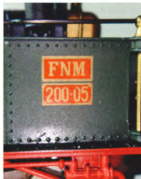
Diverse skilte er blot påtrykt - dengang var der ikke tradition for ætsede dele på modellerne.
