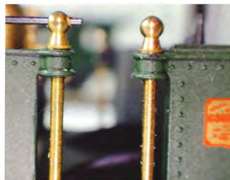
Balustre til opstigningen, lavet af drejet messing.
