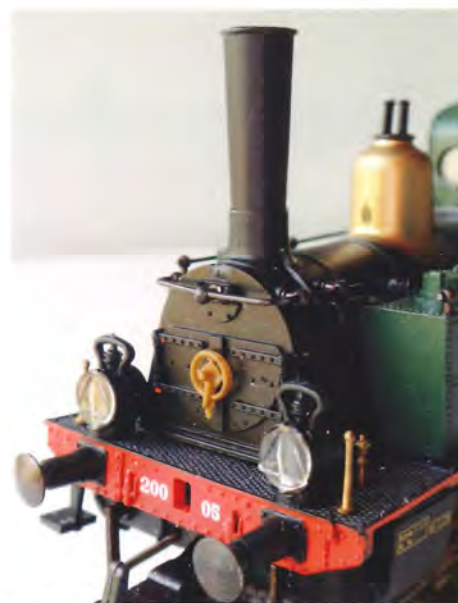
Fritstående lanterner, håndhjul, balustre m.v. og fint påtryk på pufferplanken.
