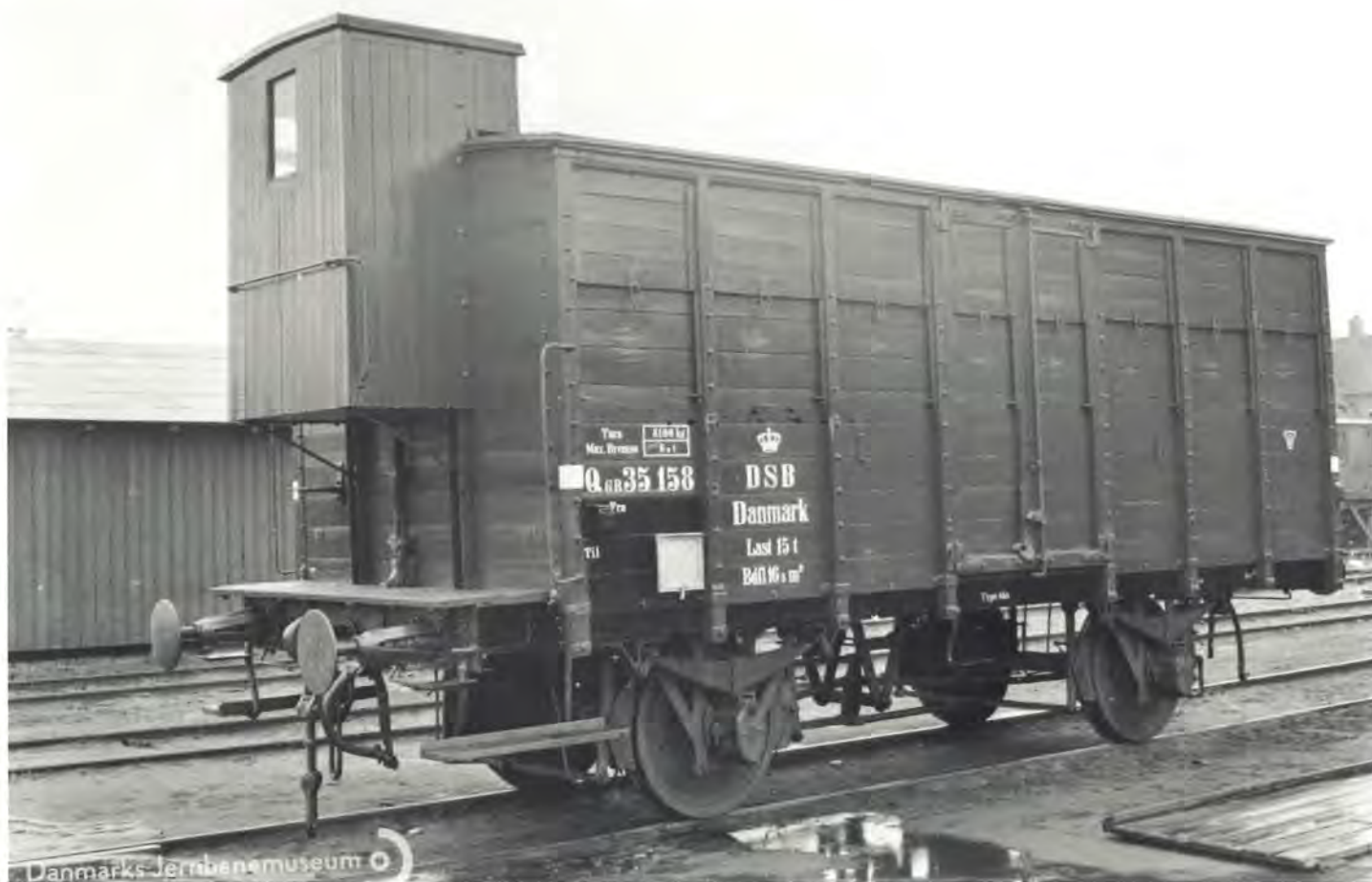
Forbilledet for DSB-vognen QGR 35 158. Det kan lige fornemmes, at bremseshuset ikke hviler oven på vogntaget. Arkiv Danmarks Jernbanemuseum.
