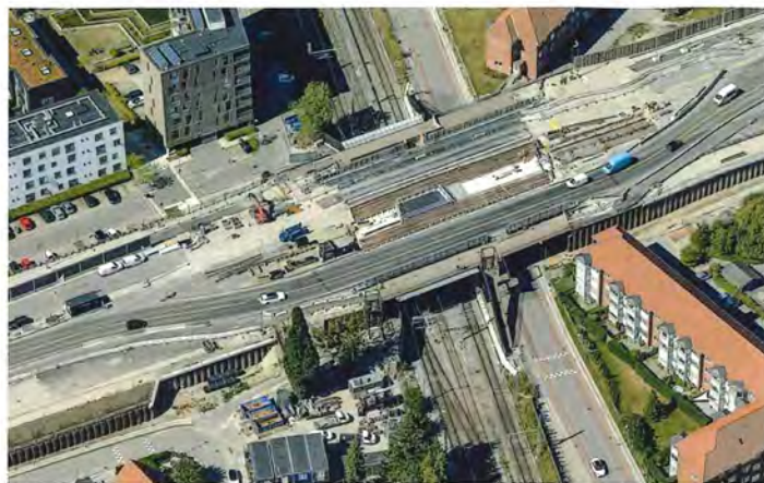
Ring 3, vejbroen over S-banen i Herlev. Det mørke område midt på broen er udskæringen til trappe fra Letbanen til den kommende S-bane perron, når Herlev Station flyttes mod nord-vest. Foto: Hovedstadens Letbane.
