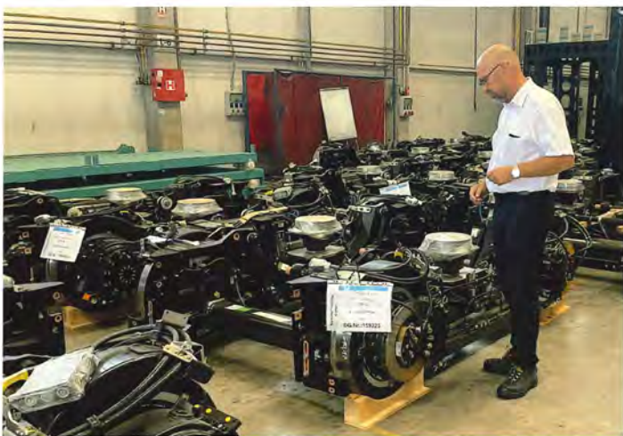
Fra fabrikken i Serbien. Boggierne til det første letbanetog står klar til montering. Foto: Hovedstadens Letbane.
