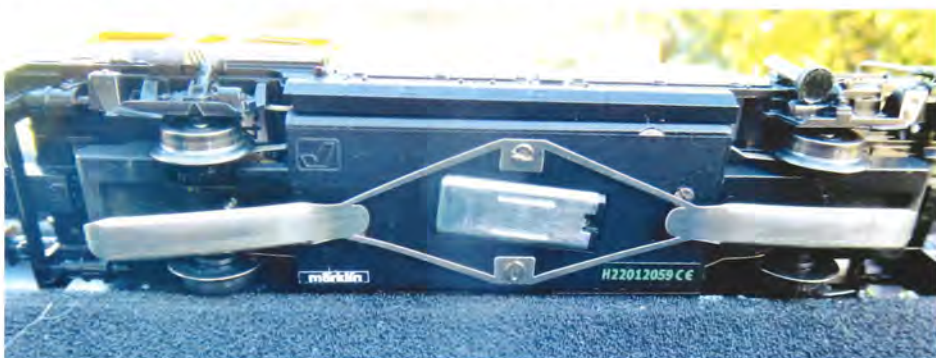
Den meget specielle, to-delte slæbesko på troljen.
