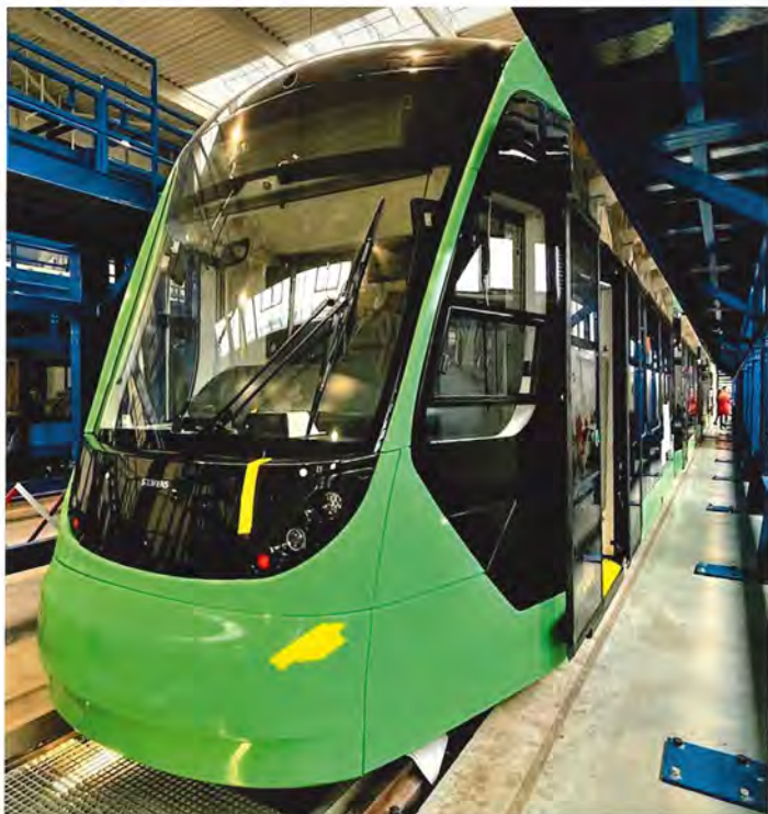
Det første, færdige letbanetog på fabrikken i Serbien i november 2022. Herfra sendes toget til Siemens i Tyskland, hvor det skal gennemgå det store testforløb, inden det sendes til Danmark i midten af 2023. Foto: Hovedstadens Letbane
