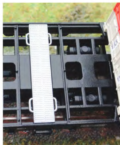
Bærevognen er fuldstændigt af metal og sikrer dermed gode køreegenskaber og 'evig' holdbarhed.
