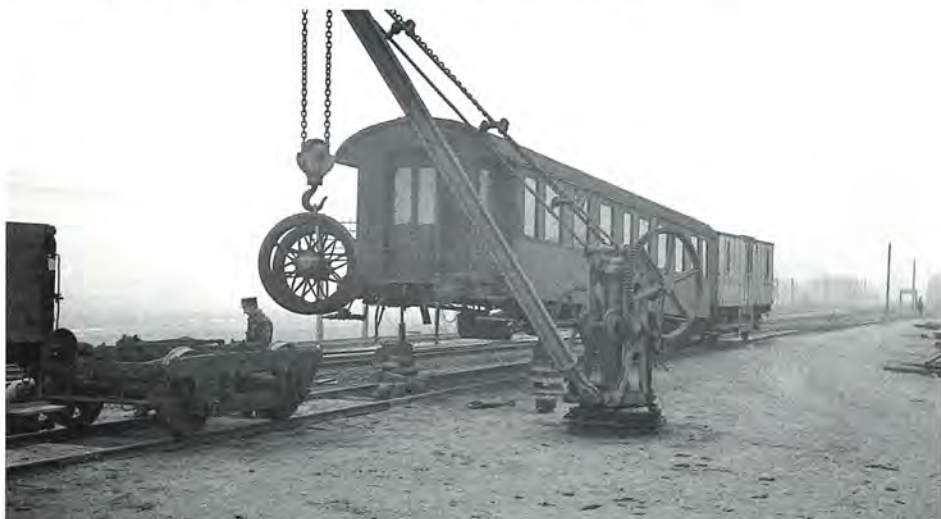
Hjulsift på bogie fra CM-vogn på Kværkeby station, april 1957. Foto Holger B.D. Sørensen.
