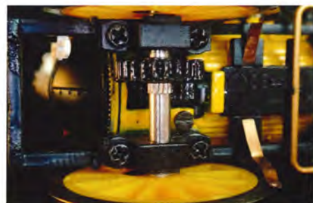
Strømoftag og drev på 'The Rocket'. Begge aksler på lokomotivet optager strøm.
