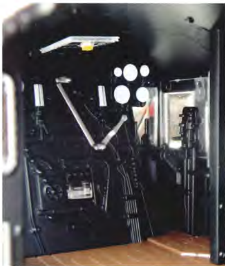
Indretning på førerpladsen - med en rolig hånd kan man måske tegne visere m.m. på instrumenterne. Pladen i loftet er en holder til ED-lyset.
