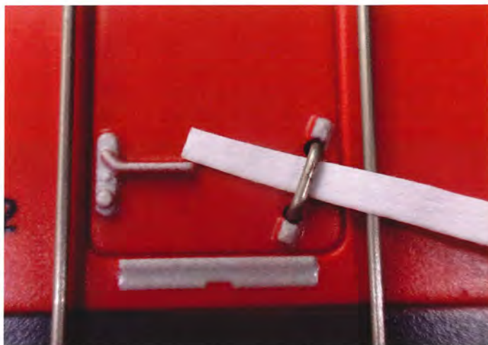
Håndgrebet er separat monteret - med luft mellem det og overdelen, som det ses af den indstukne papirstrimmel.
