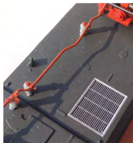
Kabelføringen på taget virker lidt skodesløs - her var hård ståltråd eller en plaststøbning bedre.
