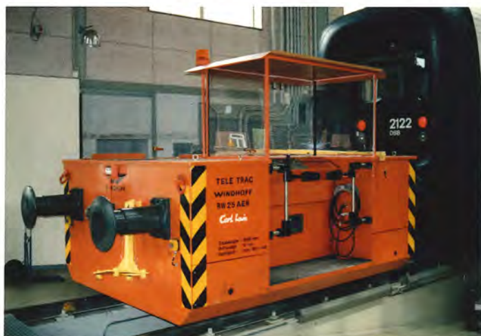
Rangerrobot 'Carl Lewis' til ER4-togene på Helgoland den 31. maj 1997. Egentlig utroligt, at så lille et 'apparat' kan flytte så tunge togstammer.
