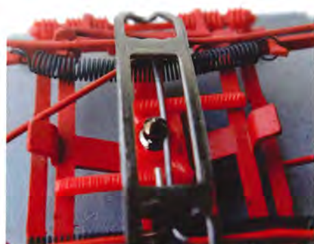
Fjederen i midten skal løsnes, når pantografen skal hæves.
