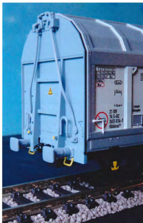
Gavlen på skydevægsvognen uden løsdelen monteret.
