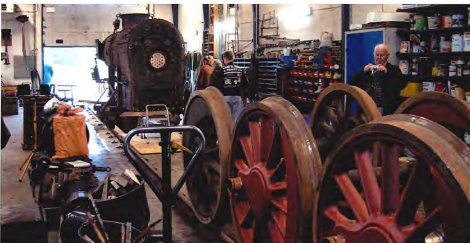
Kedlen til F 665 er klar til transport til et kedelfirma i Herning, og hjulene er kommet tilbage fra hjulafdrejning og skal have påsat tappe.
