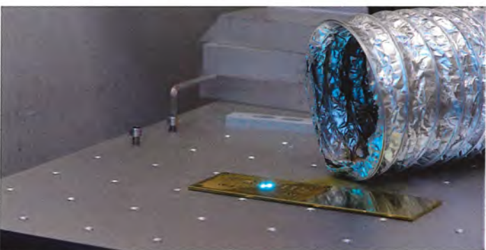
Messing under laserhovede efter første gennemløb.
