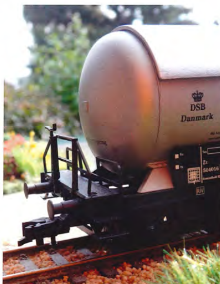
Tankvognen, set fra enden med den nye bremseplatform.
