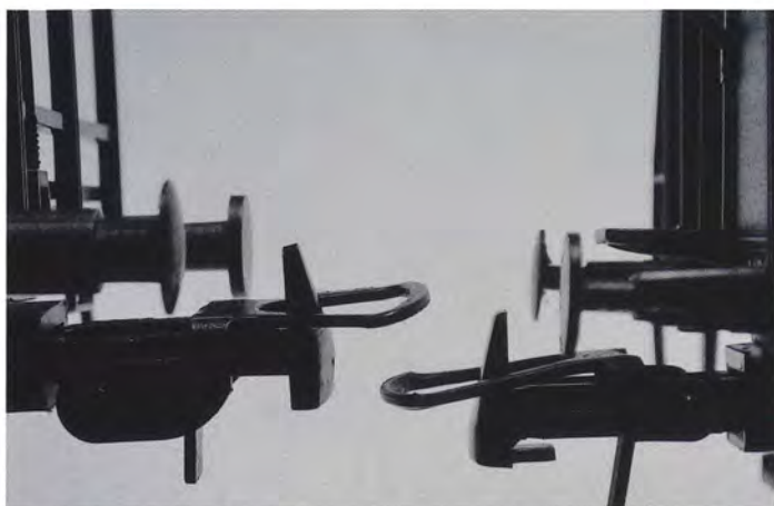
Luxol-vognen til venstre, en Roco-vogn til højre - betydelig højdeforskel ved koblingerne, og pufferhøjden er også forskellig. Foto SoB.
