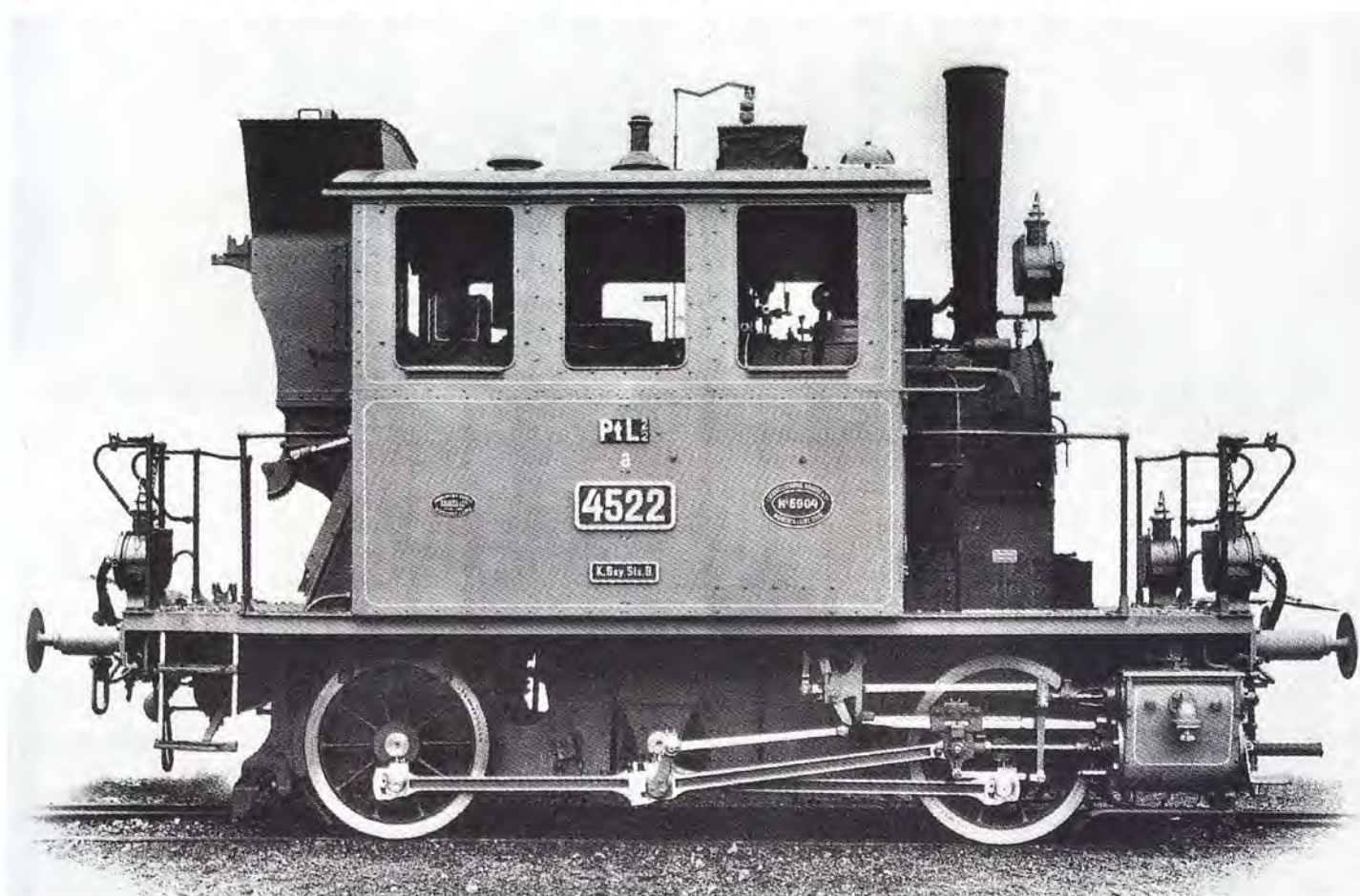
B-h2-lokomotivet fra De bayriske Statsbaner, litra PtL 2-2, bygget af Krauss 1908. Slg. SoB.
