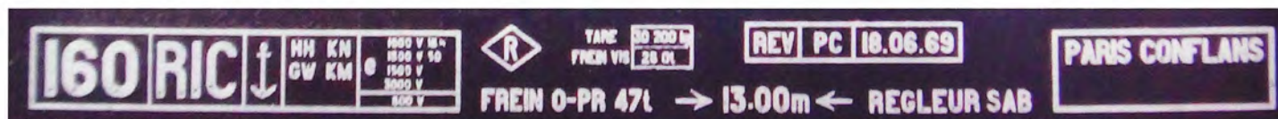
Skilte til montering på undervognen - og bemærk også, at vognen er godkendt til flere færgeruter.
