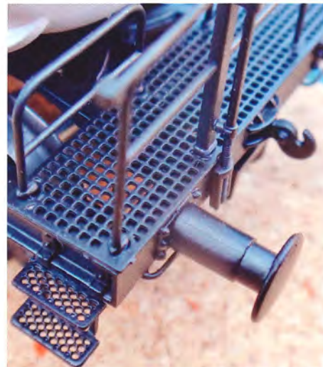
Trinbræt og bremseplatform lavet af tyndt, ætset metal med fine huller.
