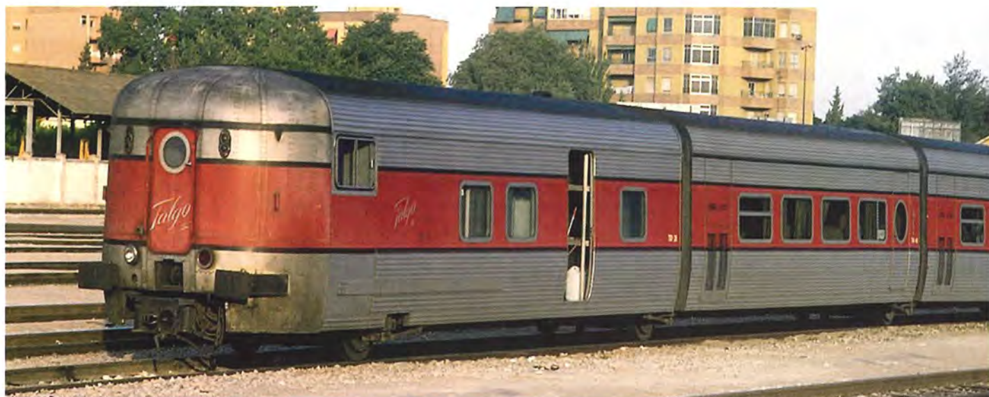
Et af de første, spanske Talgo-tog fra serie III på banegården i Granada den 26. juni 1993. Her ses en af de specielle generatorvogne. Det ses tydeligt, at vognene er betragteligt kortere end de nutidige vogne. Foto Falk - wikipedia
