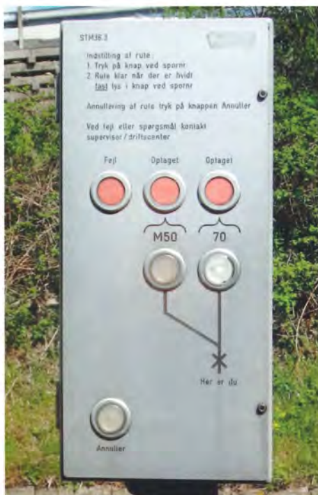
Betjeningspanelet, der selv indstiller togvejen for os - det betjenes fra sidevinduet.
