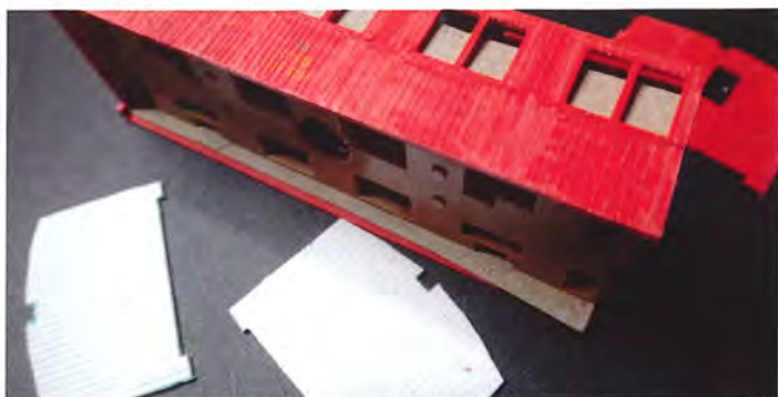
Og da dette rillearbejde var overstået, kunne et nyt begynde - fremstilling af nye gavle - også meget tidskrævende.
