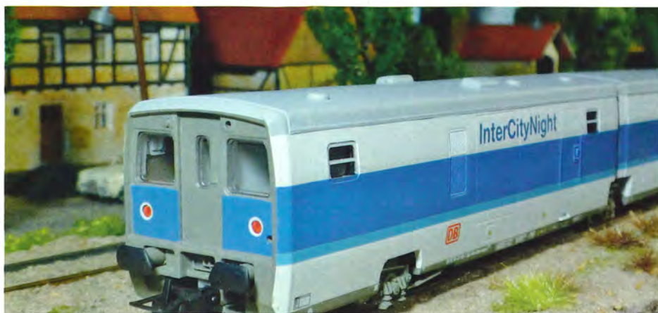
Generatorvognene har også styrerum og overgangsmulighed til endnu en vognstamme.
