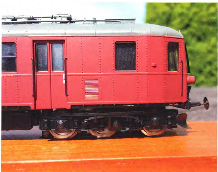
Midteraksel forkert placeret fra Heljans side - det burde have været opfanget ved kvalitetskontrollen (hvis den findes...)
