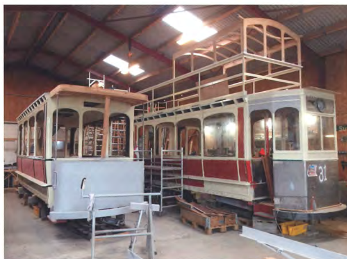
De to toetages Frederiksberg-motorvogne FS 22 og 31 i hallen på Bornholm. Som det kan ses, er der tale om omfattende rekonstruktion af de to vogne. Foto Erik Storgaard.
