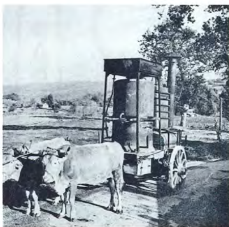
Oksetrukket, primitiv alambic i Frankrig. Slg. SoB.
