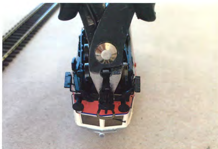
Med en skinnebidetang kan man forsigtigt lirke konblingen ud af koblingsskakten og montere en anden efter behov.
