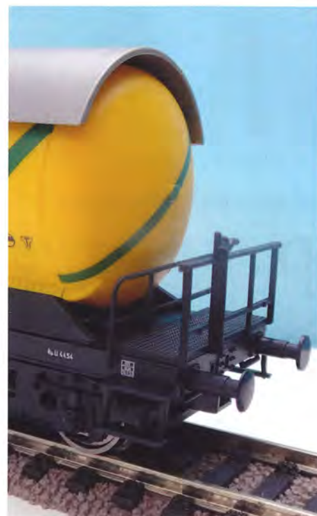
Gavl med bremseplatform - den svarer til nogle af vore Kosangas-tankvogne.
