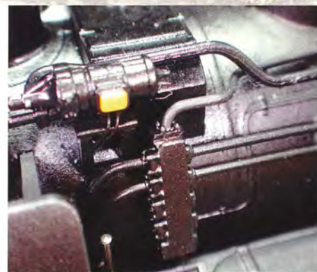
Turbodynamo og andre apparater forrest på kedlen, godt fedtet ind af udflydende dampolie...
