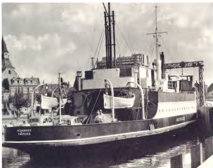
M/F Mommark i færgeløjet i Faaborg. De to rør på siden af agtermasten var "udstødningsrørene" som fattig erstatning for en anstændig skibsskorsten.
