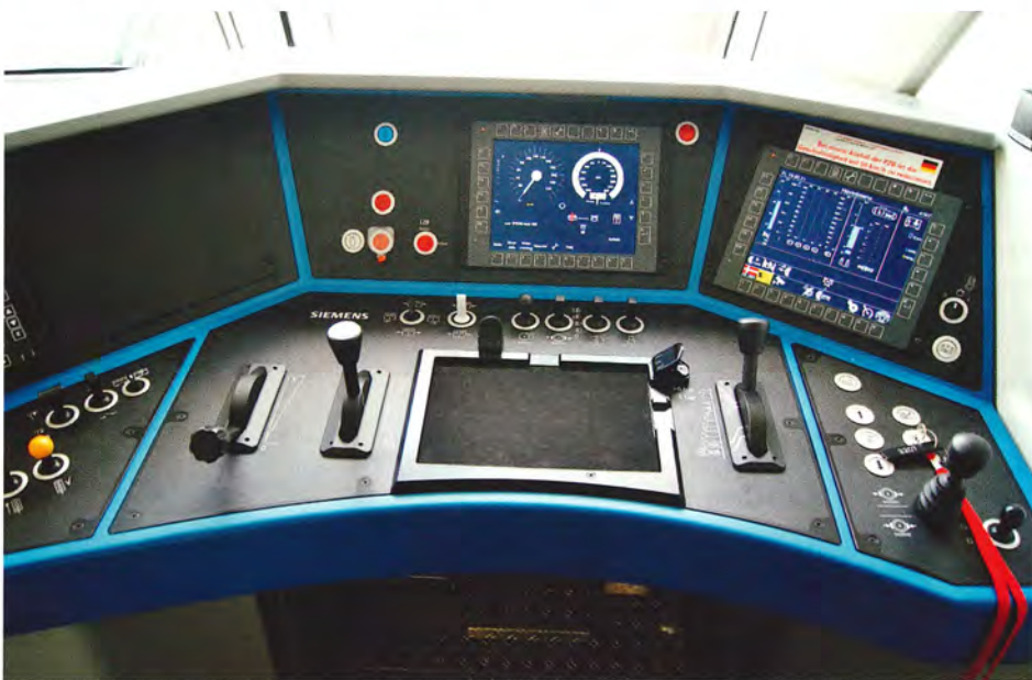
Førerrum 1 med diverse kontakter, DMI- og TDD-skærme m.v..
