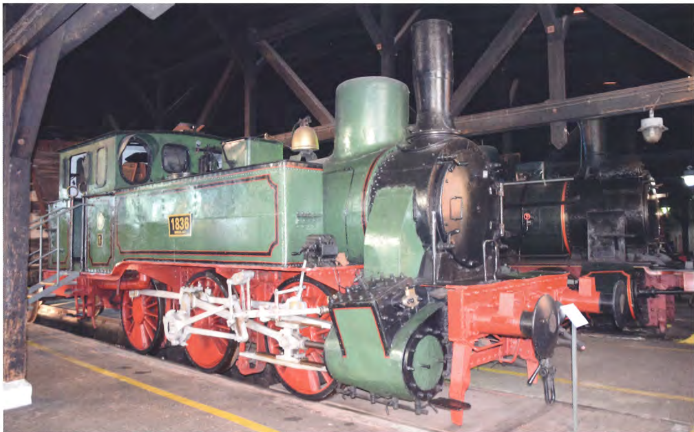
PKP litra Tk2.12, restaureret som KPEV Breslau nr. 1836, bygget af Union 1896, på Jaworzyna Slaska Museum Depot, 23. november 2017. Cirka 30 eksemplarer havnede i Polen efter Første Verdenskrig. Det sidste blev udrangeret i 1960'erne. Dette lokomotiv var i drift ved kulminen Kasimierz Juliusz Sosnowiec. Det blev i 1974 restaureret tilbage til det originale udseende af PKP. Foto Hugh Llewelyn, wikimedia commons.
