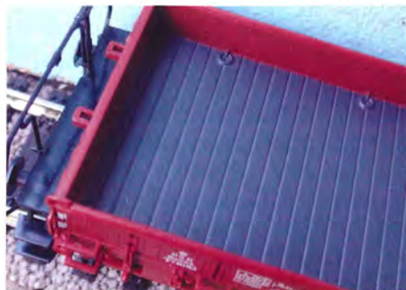
Vognbunden er fint profileret med bindeøjer.
