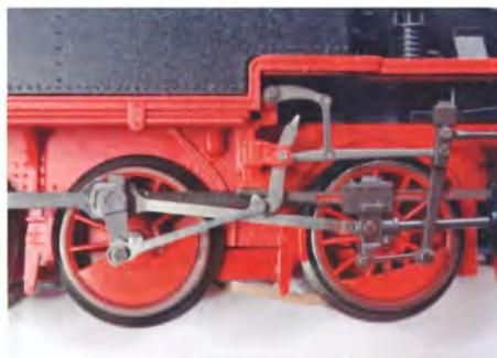
Gangtøjet er fint og veldetaljeret, og hjulene har fine eger, men kobberfolien burde ikke være synlig.
