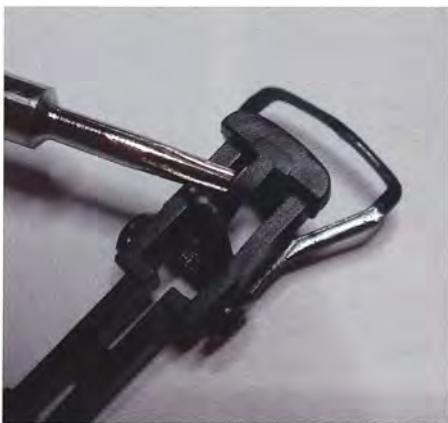
Den drilagtige flig på undersiden af koblingen fjernes nemt med en kniv eller saks.
