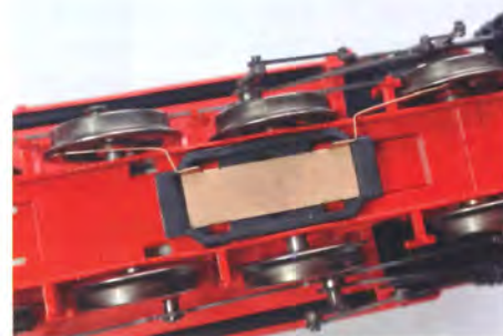
Ret enkelt og underdimensioneret strømoftagersystem med blot to kobberflige i den ene side.
