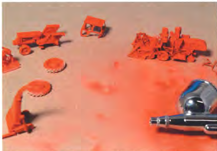
Et tyndt lag maling i farve kan bedst påføres med air-brush.
