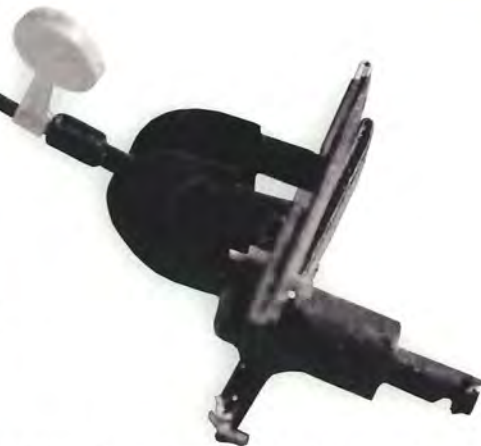
Rocos sporskifter har en lille tap (nederst til højre), som omstilleren limes fast på, hvorefter den kan genplaceres.
