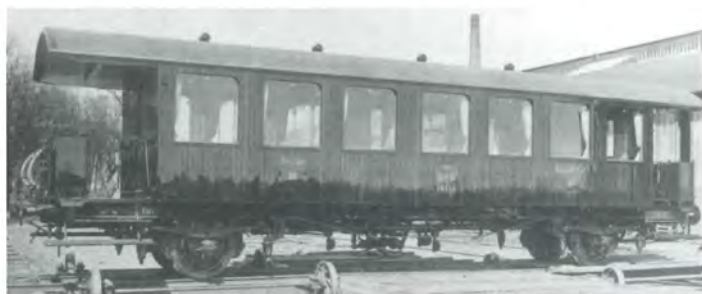
Den nylakerede Cx 10115 fra 1923, en typisk rystevogn. Senere betegnelse var Cx 4505. Vognen blev udrangeret i 1968. Foto Scandia.
