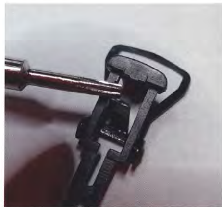
Og her er fligen klippet af - så kobler vognen straks meget bedre.
