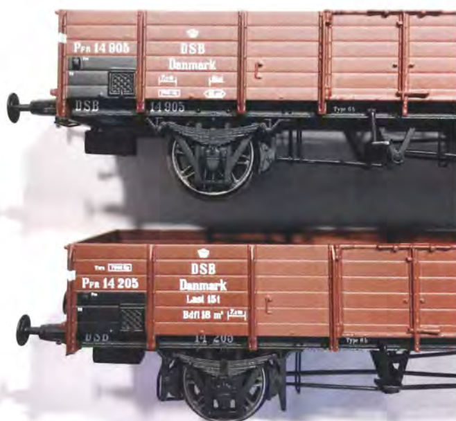
To af varianterne med enkelt hhv. otte bremseklodser. Bemærk også forskellen på påskrifterne. Foto Vagn Holstein.
