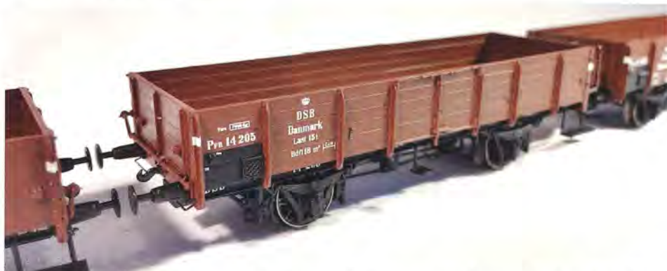
PFR 14205 - en af typerne med lille bremseplatform og otte bremseklodser. Foto Vagn Holstein.
