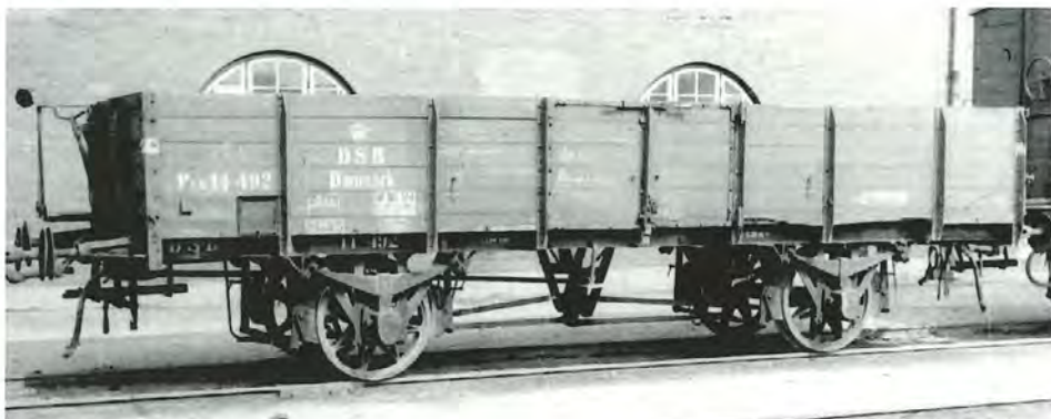
En af vognene med lille bremseplatform og otte bremseklodser, PFR 14 492, på Centralværkstedet København 1964. Bremsebukken sidder centralt inde på undervognen. Foto P.C. Johansen.
