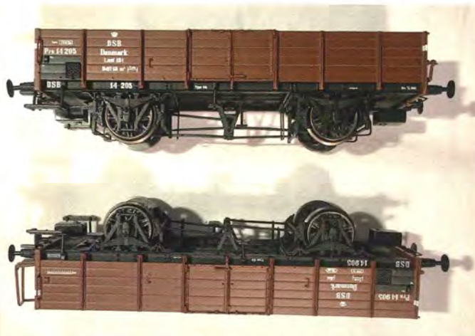
Nej, det er ikke et spejlbillede, men det viser to varianter mht. bremseudstyr og påskrifter. Man skal holde tungen lige i munden for at holde rede på dem. Foto Vagn Holstein.
