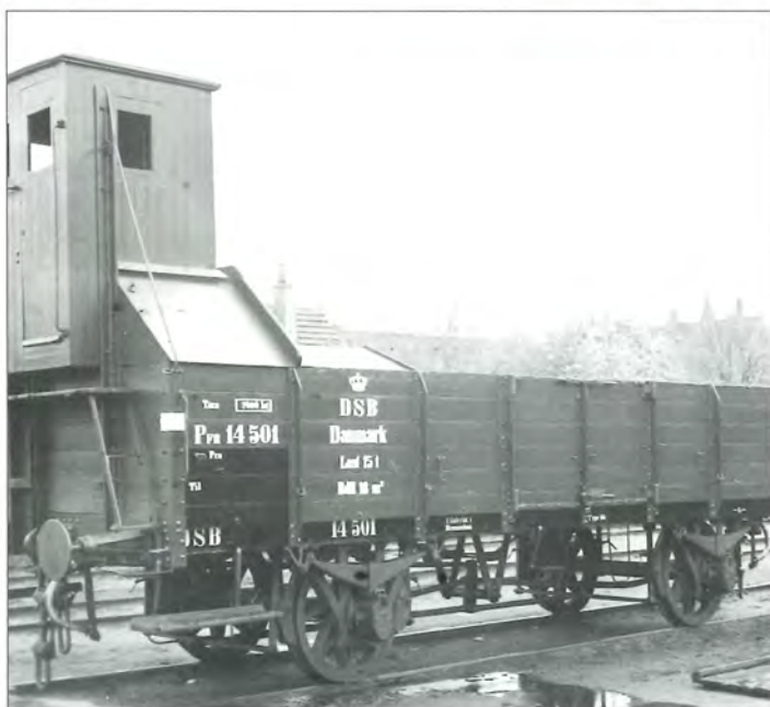
Et Brændegårdsbillede af PFR 14 501 med bremsehus. Foto DSB.
