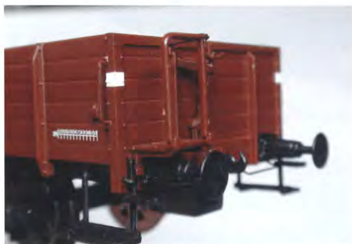
Gavlen på en PR-vogn med lille bremseplatform - meget flot detaljeret. Foto Flemming Søeborg.
