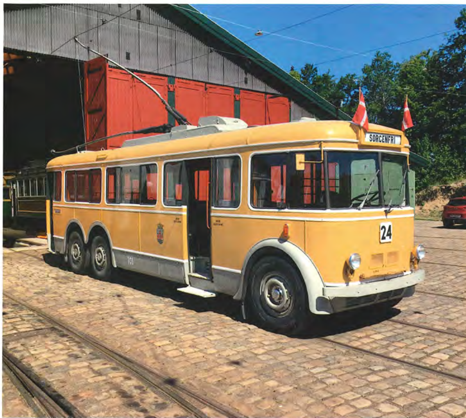
Fra eftersyn på værksted ud til testkørsel. Den ene stang er på køretråd og slæbesko i skinnen. Foto Erik Storgaard.
