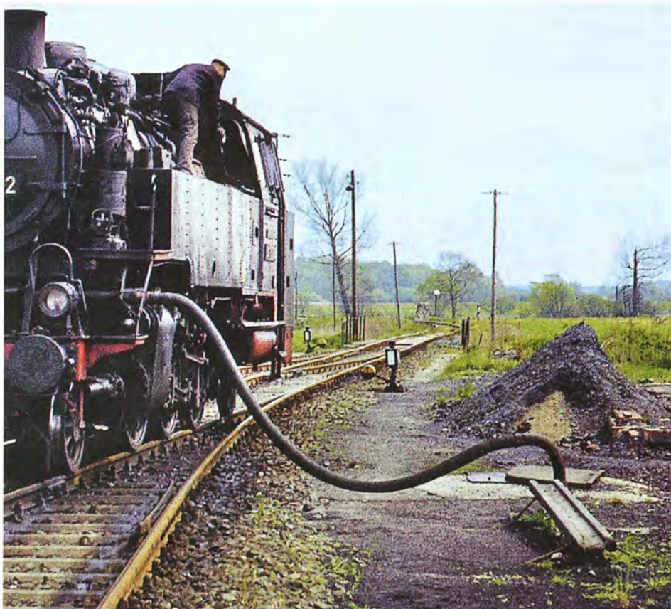
Billedet her drejer sig mere om ballastens farve og struktur end om 64'eren, som dog også er et syn værd. Den tager vand via et pulsometer. Foto Winkler.
