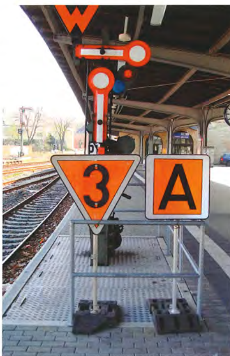
Og så blev det Goslar, hvor dette herlige, nittede 'dværghsignal' stod på perronen, komplet med Warte-Zeichen og hastighedstavler.
