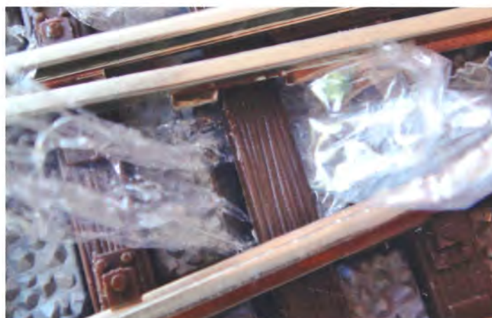
Min metode til (delvist) at undgå lim i de vitale dele på sporskifter - køkkenfolie trukket ind under svellerne.
