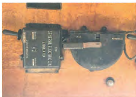
Til venstre en stor maximal-afbryder og til højre omskifter mellem køretråd og skinne for minusforbindelsen. Foto Erik Storgaard.
