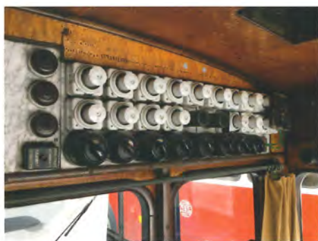
I en trolleybus er der mange afbrydere og omskifttere samt sikringer. Foto Erik Storgaard.
