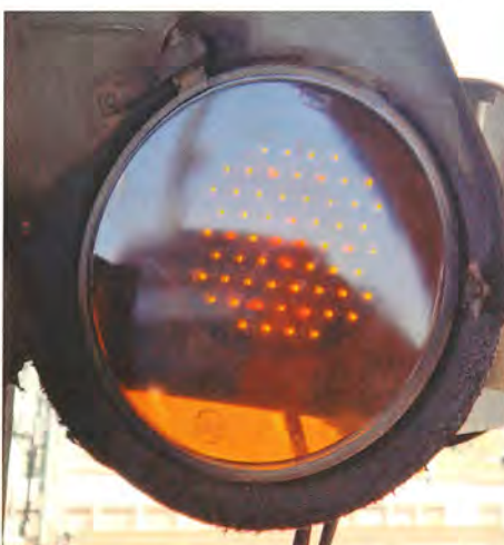
Moderne teknik i det 100-årige signal - lysdioder i stedet for glødelamper.
