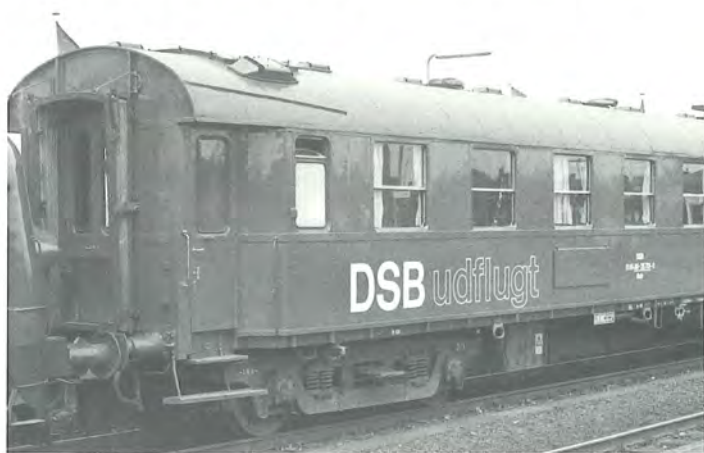
Buh 701 ved perron i Nykøbing F. Bemærk de løse plader på siderne. Foto Per Topp-Nielsen.
