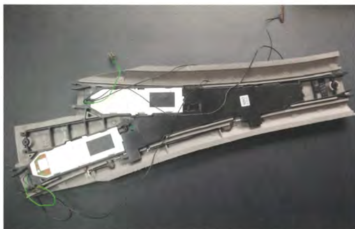
Ledningerne med lasker er til strømforsyningen til drevet. Den grønne sættes på skinnen, når drevet skal programmeres. Det skal gøres på separat programmeringsspor for hvert drev.
