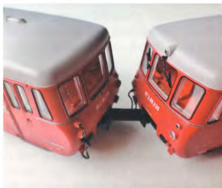
Den faste, elektriske kobling kobler tæt, men der er også stort spillerum, da der ikke er buffere på vognene.
