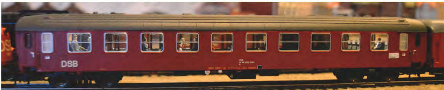
Det færdige resultat. Lyset i gruppe C (kupe 7-8) er her slukket vha. funktionstasten F5 på CS3.
