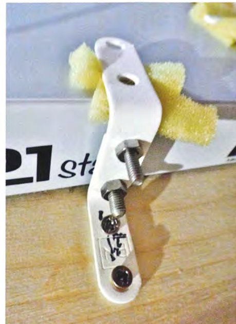
Z21-enheden skal monteres med hjemmelavede beslag, lavet af små, sammen-skruerede vinkler med skumgummi som beskyttende 'indlæg'.
