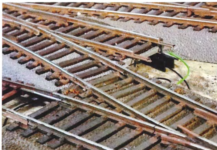
Det lille, grønne kabel skal sættes på en af skinnerne og bruges ved programmeringen af sporskiftedekoderen. Herefter gemmes ledningen under ballasten.
