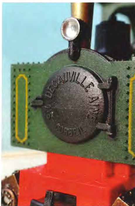
Røggaskammerdøren på 'Steattie' - konstruk-tørerne har gjort et flot arbejde. Foto SoB.
