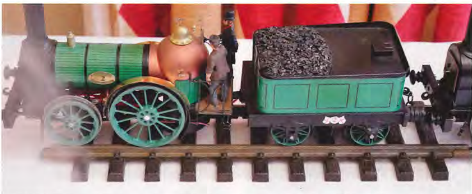
David Viewings 3D-printede model af London & Birmingham No. 2, bygget af Edward Bury ligesom et stort antal andre af same type til banens åbning i 1837. Den runde fyrkasse var karakteristisk for Bury's lokomotiver, der ellers meget lignede Robert Stephenson's Planet-type. Robert Stephenson brugte kun sådanne runde fyrkasser, hvis kunderne insisterede på det, som ved bestillingen af det første effektive damplokomotiv i Nordamerika, "John Bull", leveret i 1831. "Tågen" forrest i billedet er røg fra et af Davids andre udstillede lokomotiver. Lokomotiv-modellens motor er placeret i tenderen. Foto PT.
