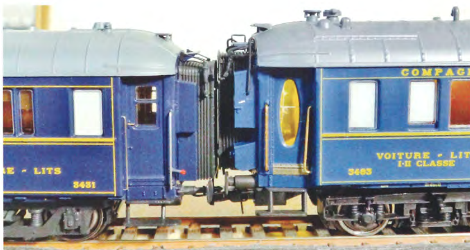
L.S.M til venstre, Jouef til højre - ret store forskelle på vognkassefarve, detaljer, vognhøjde, pufferlængde og finhed af detaljerne.
