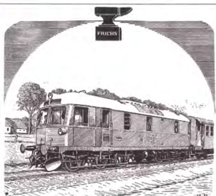
750 hk diesel-elektrisk lokomotiv 9 stk. leveret 1952 til danske privatbaner
