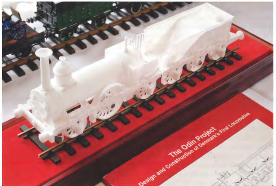
David Viewings 3D-printede model af ODIN i størrelse 10 mm til en fod (dvs. 1:30,48, altså ikke meget forskellig fra spor 1's 1:32), printet i nylon på grundlag af tegningerne i Bailey & Glithero: "The Odin Project", udgivet af Danmarks Jernbanemuseum i 2004. Foto PT.
