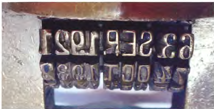
Nærbillede af stempelvalserne - indstillet på 63. sep. 1921....
