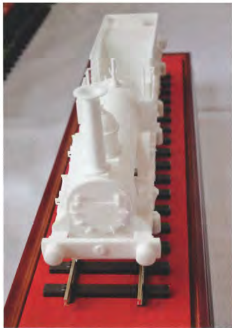
David Viewings 3D-printede model af ODIN i størrelse 10 mm til en fod (dvs. 1:30,48, altså ikke meget forskellig fra spor 1's 1:32), printet i nylon på grundlag af tegningerne i Bailey & Glithero: "The Odin Project", udgivet af Danmarks Jernbanemuseum i 2004. Foto PT.
