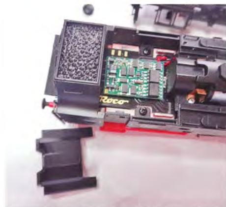
Under døren har dekoderen sin plads.
