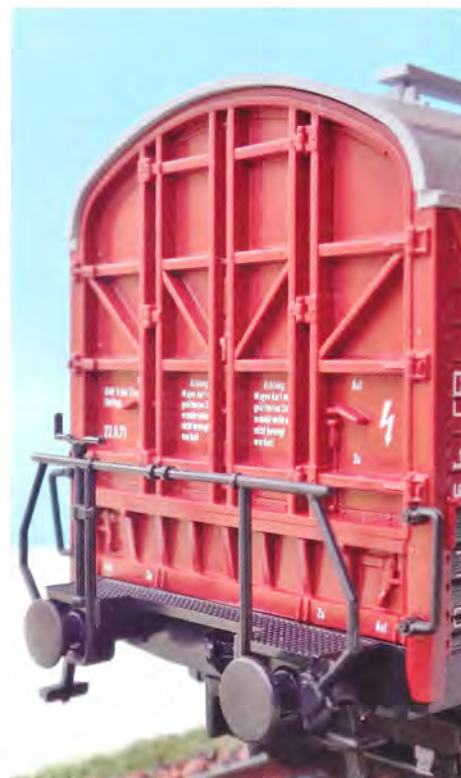
Flot vogngavl med bremseplatform. På taget er der løbebro i begge ender, på vognsiderne flotte påtryk. Håndbøjlerne er dog alt, alt for kraftige.
