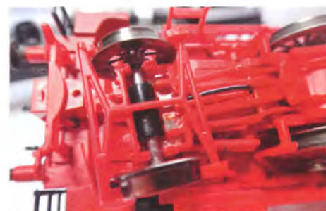
Strømoftag på for- og efterløber giver gode køreegenskaber.
