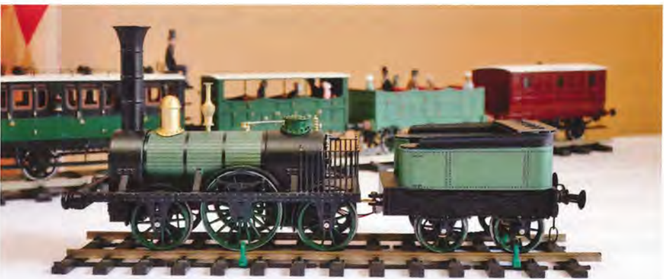
David Viewings 3D-printede model af Robert Stephenson's Patentee-type, som den så ud ca. 1838. 3D-printet på baggrund af tegninger oprindeligt trykt i W.P. Marshall's bog: "Description of the Patent Locomotive Steam Engine of Messrs. Robert Stephenson & Co.", i 1838 og i de følgende år gengivet mange steder. I baggrunden ses nogle af Davids samtidige vogne i "Spor 1" fremstillet i ætset messing. Foto PT.
