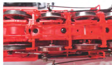
Stor, sideværts bevægelighed på drivakserne er med til at give den gode kørsel.
