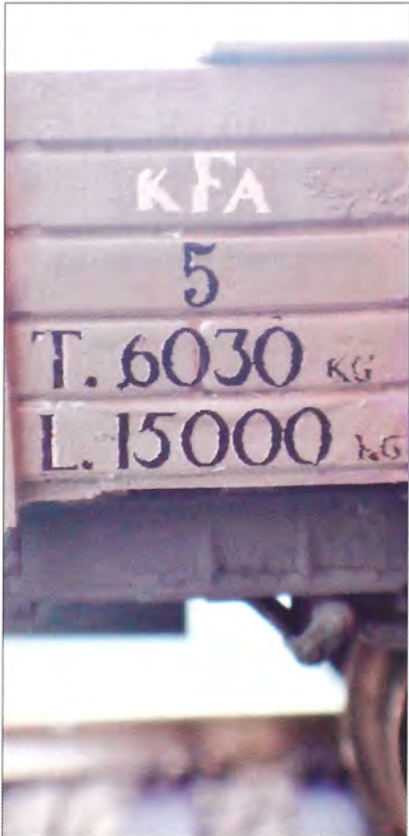
Nærbillede af den specielle litrering - men det er korrekt med det 'forhøjede' F.
