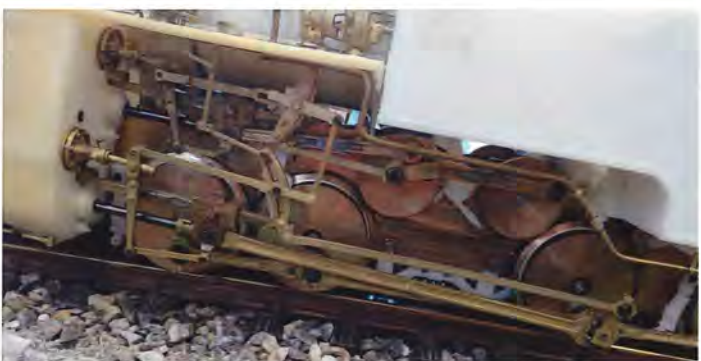
Gangtøjet på den nye Furka-model fra LGB – meget fascinerende og ret kompliceret
