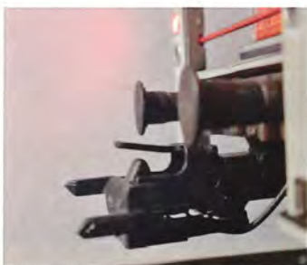
Koblingen på BR 290 før bevægelse - og koblingsarmen løftet.
