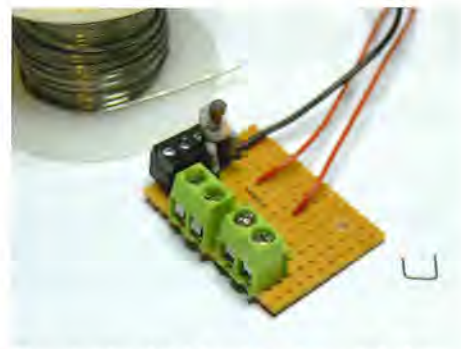
Terminal-udvidelse. Løsningen på det evindelige problem med at få plads til de mange ledninger.
