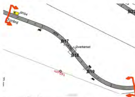
Udsnit af skinneplanen, hvor der indbygges en lang spormeldekontakt (K16)
