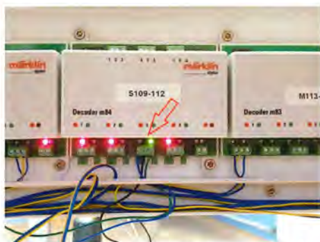
Dekoder med adresse 111 for tænd/sluk af elektronikmodulet.
