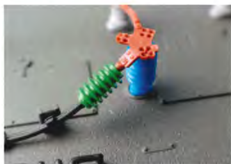
Kulørte isolatorer lever lidt op på taget af BR 193. Foto SoB
