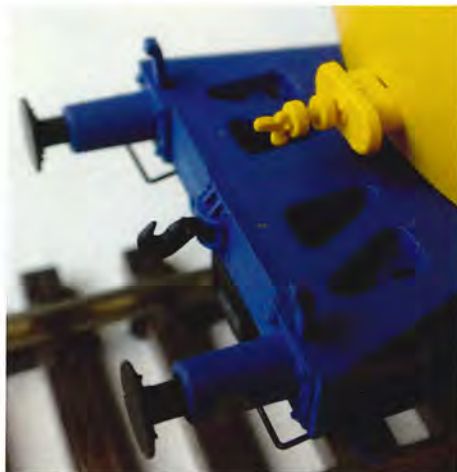
Endegavlen med de skrå profiler og varmelædningsstudsene. Foto SoB
