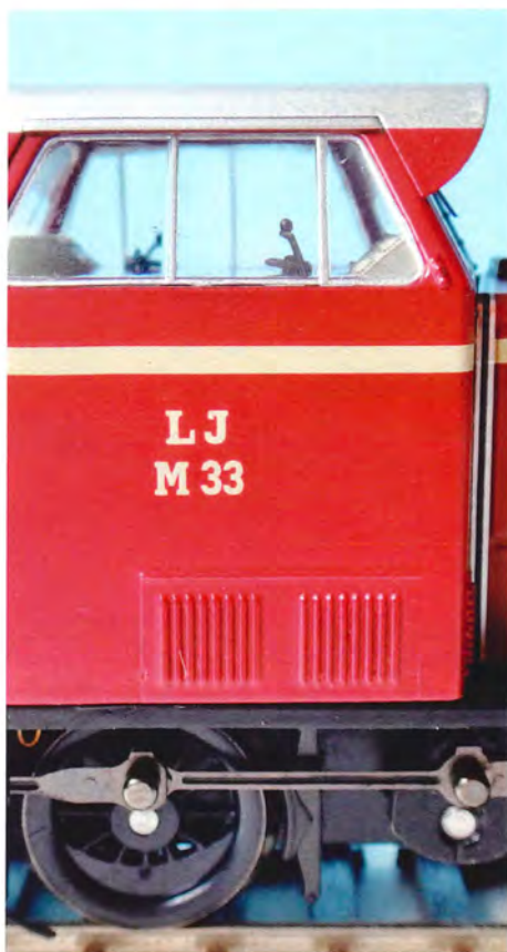
Førerhuset på LJ M 33 - mere 'bart' end HFHJ-modellen. Desværre sidder sandrørene et godt stykke udenfor hjulene, men måske kan man forsigtigt bøje dem ind
