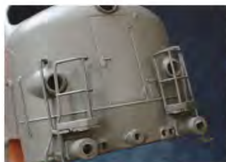
Fronten med prøvemontering af rangerplatforme
