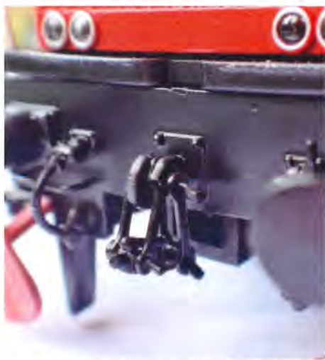
En lækker detalje - ægte modelkoblinger, der er forudmonteret. Bagved ses skakten til NEM-koblinger. Læg også mærke til de fine lamperinge i sølv
