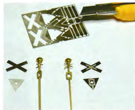
De ætsede dele skæres forsigtigt ud af rammerne
