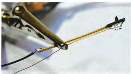
Kontrol-signal med påloddet diode og ledninger
