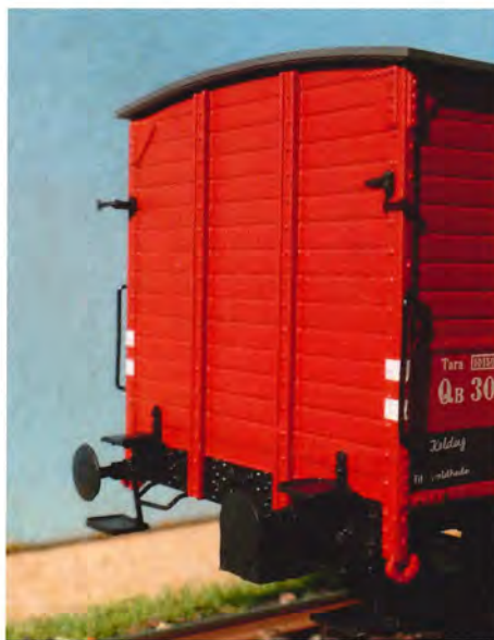
Korrekte U-profiler på TKVJ-vogn gavlen.
