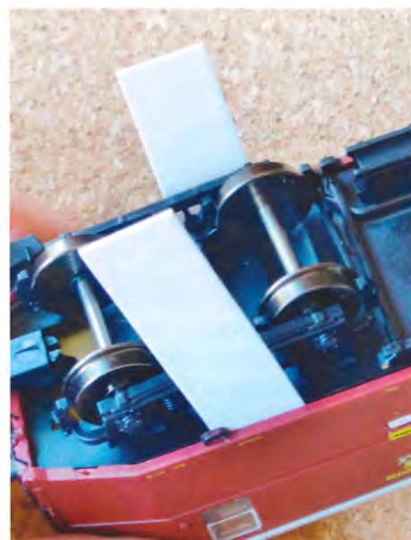
En hjælp ved adskillelsen er nogle plasticstrimler, der kiles ind mellem overdel og undervogn.
