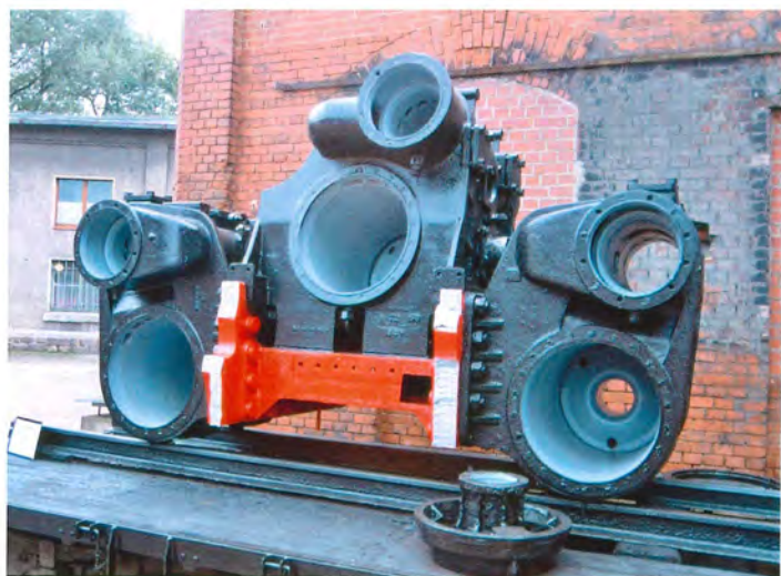
Cylindergruppen på en BR 44, Sächsisches Eisenbahnmuseum. Foto Liesel, wikimedia commons .
