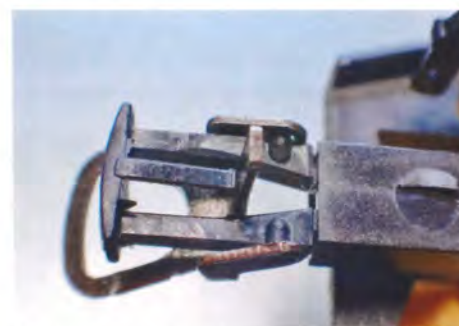
Selvhæmmende kobling - mit råd er - fjern midterstrimlen, så bøjlen har frit spil.
