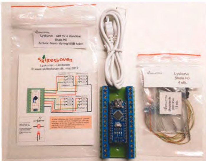
Sættet med fire lyskurve og Arduino-modul med diagram.
