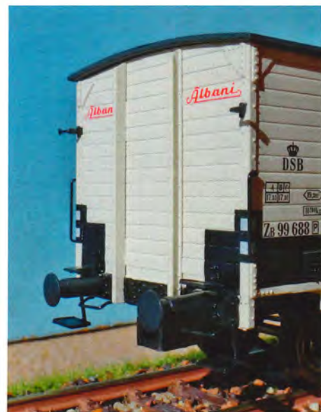
Kantstillede U-jernsprofiler på Albani-vognen - helt efter forbilledet.
