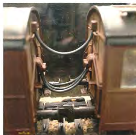
To S-togsgavle med fastmonterede kabelforbindelser m.v. Foto Niels Hjeresen.
