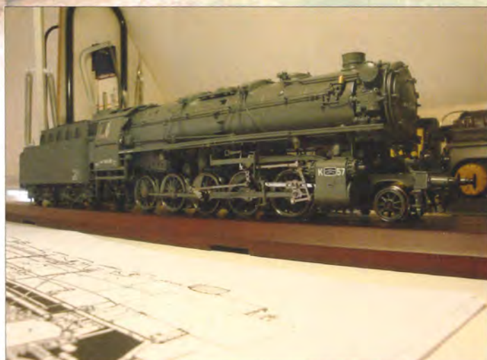
MTHs BR 44 1246. MTH leverer modellen fastskruet – ganske let hævet – til en nydelig træplade med hjulflangerne holdt fast i fræsedede spor. Den lille åbning nederst tillader udtræk af et par kørestrømsledninger, så modellen kan køre 'svævende' over træpladen. Foto Bent Ravnild.
