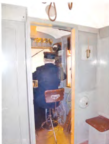
Elektroførerens lille førerrum på MM-motorvognen - togføreren havde et lignende rum ved siden af. Foto SoB.
