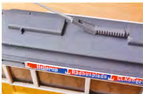
Trolleystangen, fjedrene og sideskiltene på taget.
