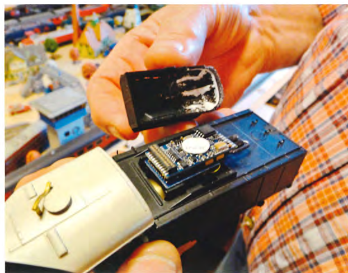
Ved at gøre kulbeholdningen større er der blevet plads til en dekoder med mange funktioner.
