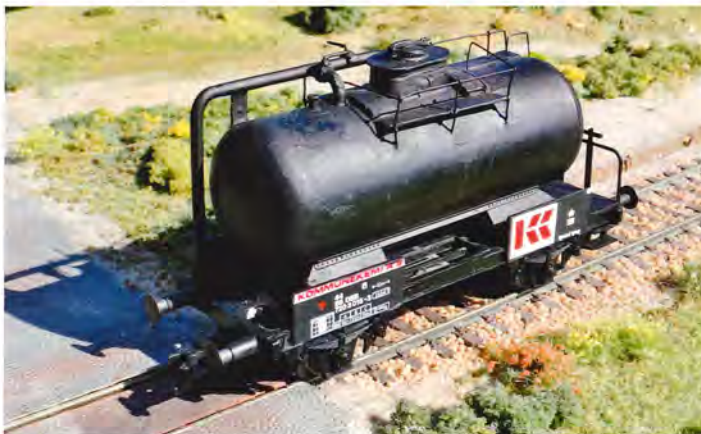
Nærbillede af den ombyggede Kommunekemi-vogn med nye rørforbindelser, dome og platform.
