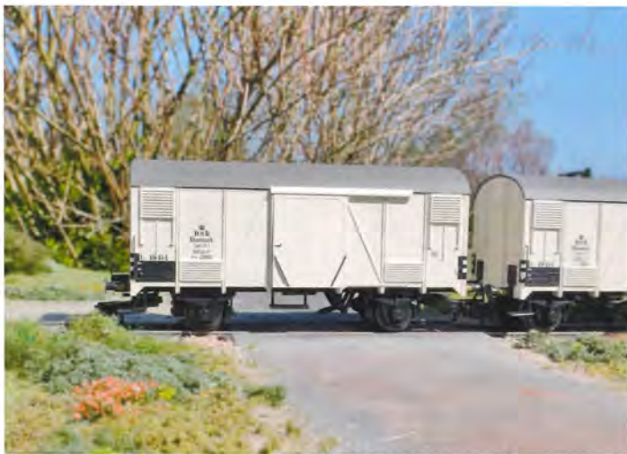
IA-vognen med den ældre undervogn med kortere akselafstand.
