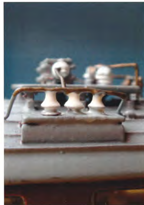
Detalje af isolatorer på taget. Foto SoB.
