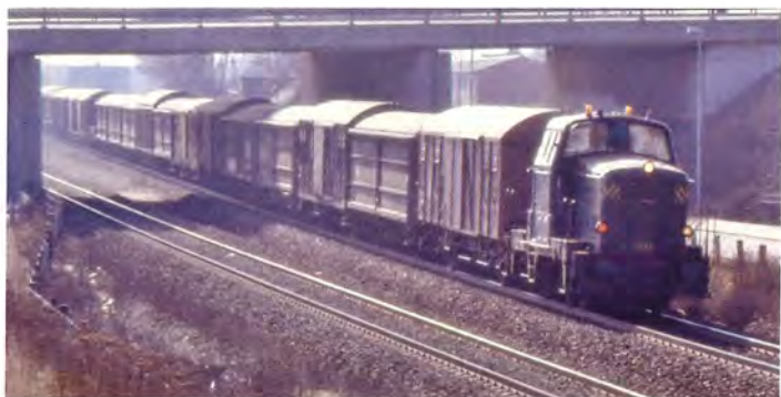
MH 321 kører med et godstog fra Hasselager på venstre spor og har derfor én rød og to hvide frontlanterner tændt den 18. marts 1985 - et sjældent syn i dag. Foto Leif Ørndorf.
