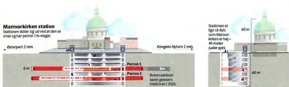
Skitse af Marmorkirken Station. Perronerne ligger over hinanden, den nederste i 40 m dybde. Illustration Metroselskabet.
