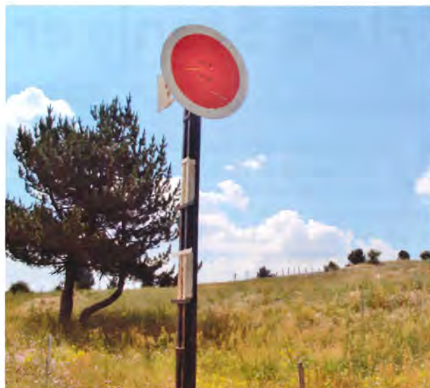
Et typisk skivesignal med betydningen 'Stop' ved FCL. Foto Vittorio Lasca - Wikimedia Commons.
