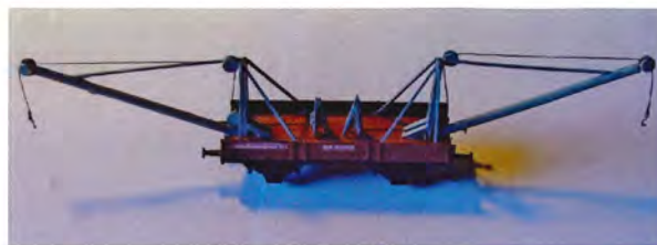
Skinneudlægningskran i spor N, bygget af Børge Sundahl, som også har fotograferet den.
