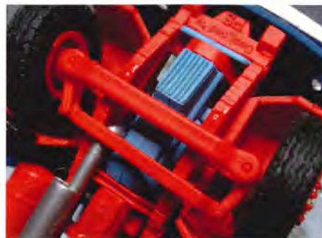
Den kraftige travers skal limes fast, så man undgår at tabe hjul og andre, bevægelige dele fremover.
