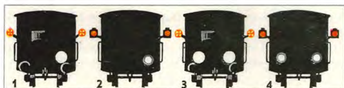
Signal- og lygteføring bagest på tog anno 1934. Slg. FS.
