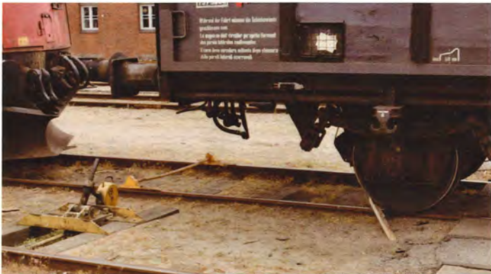
Også en form for sporstopper - et stykke træ til afbremning af godsvogn. Bemærk også den dobbelte 'hund'. Svendborg medio maj 1993.
