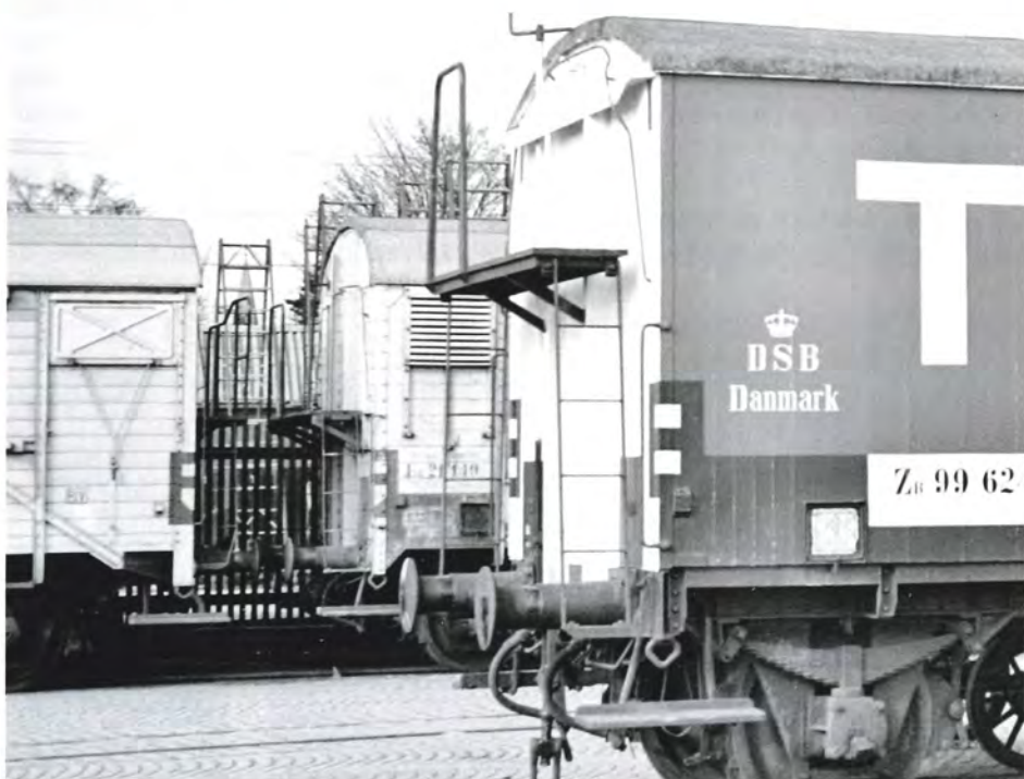
Platformene på de to hvide vogne i baggrunden vil være tæt på hinanden, når vognene kobles sammen, men pufferne vil stadig rage længere ud. Hellerup, maj 1957. Foto HBDS.
