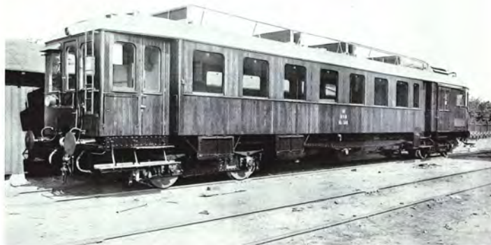
Tagkølerne på ML 508 synes at være de originale. Slg. SoB.
