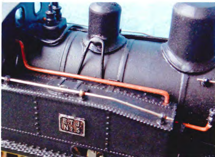
Kedel, vandkasse, domer og rørføringer.
