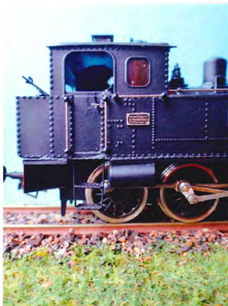
Førerhus og nærbillede af nitterækker, skilt, håndbøjler m.m.
