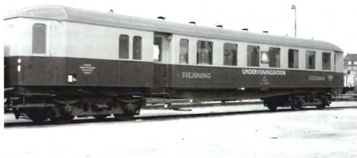
Ved ombygningen til undervisningsvogne blev motorrummet dækket af i det ydre. Vogn ZU 99993 i Århus 1963. Foto Vagn Holstein.
