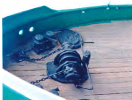
Forskibs er der ankerspil og pullerter samt spygatter. Bemærk også dæksplankerne - ægte træ, indfarvet og patineret.
