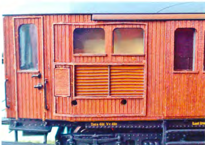
Motorrummet med eksterne kølere og fint træværk. Den forreste lille køler var ret sjælden på ML-vognene.
