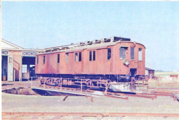
På drejeskiven står M 5 fra 1928. Heldigvis havde den ikke lænkeaksler men bogier og 275 hk.
