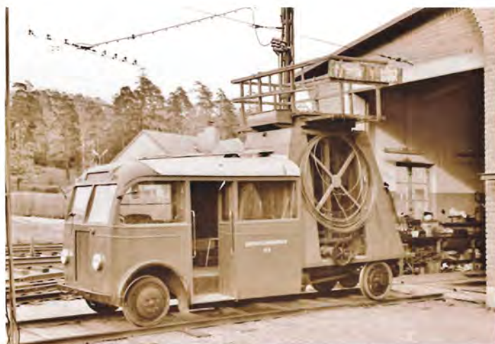
Lidingö-banen varetog også bustrafikken på øen gennem datterselskabet Lidingö Omnibus AB. En af deres busser blev ombygget til tårnvogn til banens køreledninger. Den ses her ved AGA i 1968. I dag er den bevaret ved nostalgimuseet Mannaminne i det nordlige Sverige
