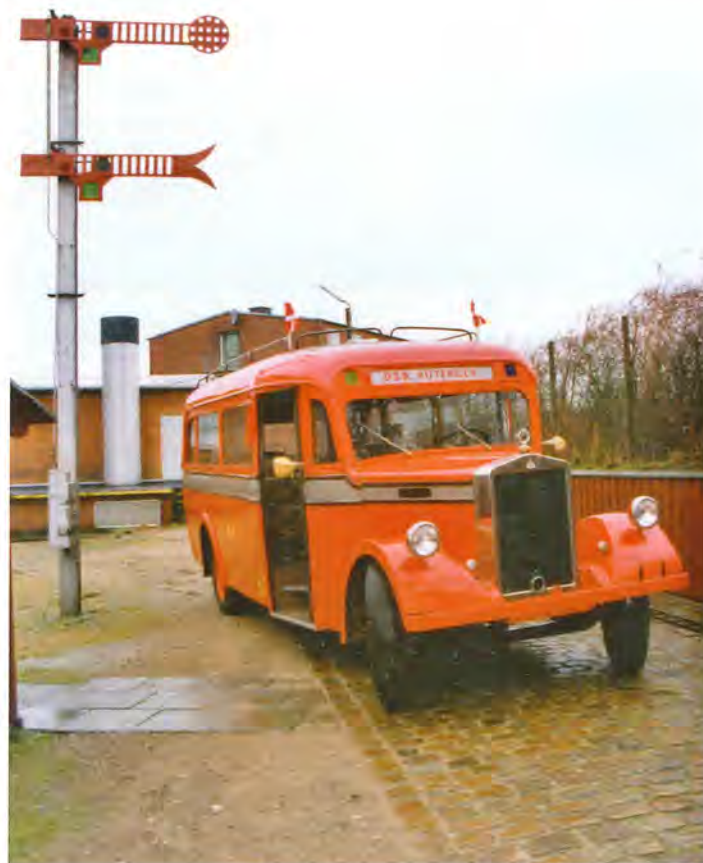
I 1934 fik DSB denne rutebil fra Triangel. Den kørte indtil 1952 på Vestsjælland og havde gasgenerator under Besættelsen. Den er fotograferet på Jernbanemuseet i år 2000. Foto FS.
