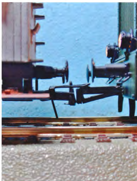
Kobling med A-koblinger fungerer også perfekt, men bedst når vognen har en vis rullemodstand.
