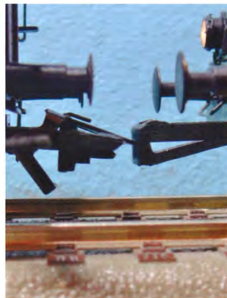
På Märklins kortkobling hænger bøjlen for langt nede - sammenlign med billederne med Roco-koblinger.
