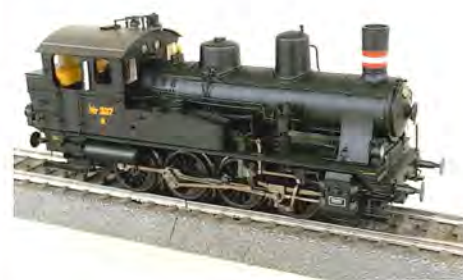
Q 337 med de lave vandkasser og kurvepuffer -
