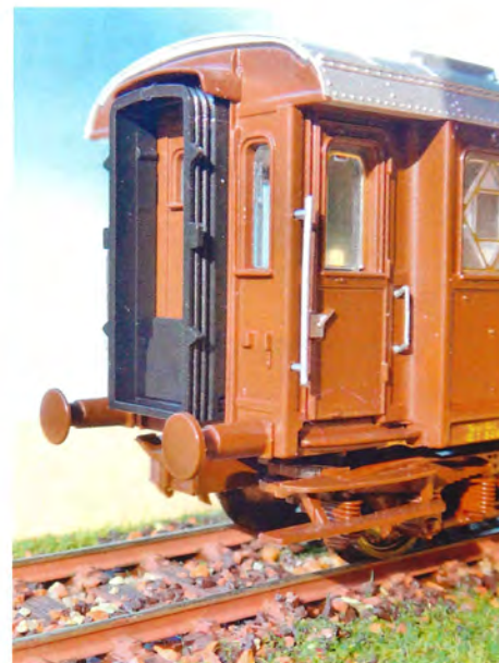
Den modsatte gavl med indslået harmonika og fodpladen slået op.
