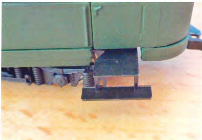
Trin, der svinger ud på en plade – det er absolut ikke tidssvarende og kan gøres bedre.
