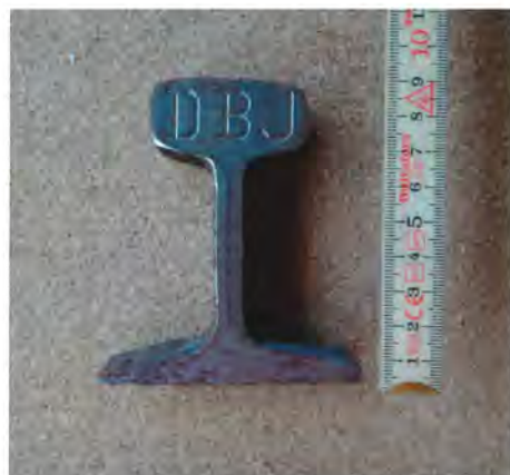
Nummeret skinnestykke fra Rønne fra museet i Nexø. Det var ikke store profiler, der blev anvendt, 19,9 kg pr. meter. Skinnen har nr. 2359, så der er altså solgt nogle stykker.
