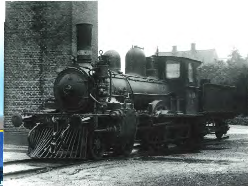
DSB IF 114 henstillet i Nyborg august 1951. I forhold til billedet fra 1900 bemærkes kofangeren, sandkassen på kedelryggen, nye cylindre med rundglidere samt den i forhold til Trick-styringen meget spinkle Heusinger-styring. Af DSB er lokomotivet i 1949 blevet forsynet med skorstensbånd og kompressor til trykluftbremsen (foto DSB).
