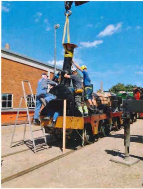
Så skal skorstenen på plads. Foto SoB.
