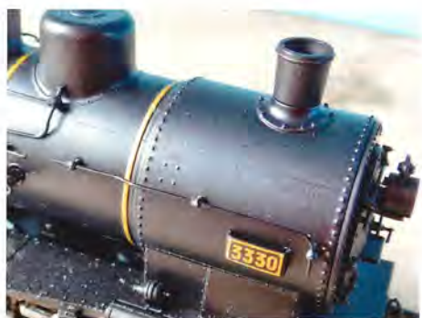
Dome, skorsten, nummerskilt m.v. - og bemærk, at der er ikke skillelinie midt på kedlen, som det ellers er almindeligt på plastmodeller - et eksempel på den gennemtænkte konstruktion.
