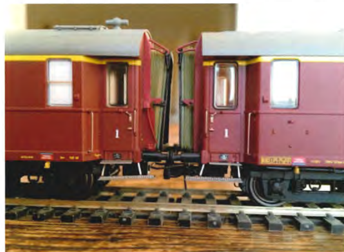
Fungerende harmonikahængere og meget spinkle trin, der kræver en dråbe lim.
