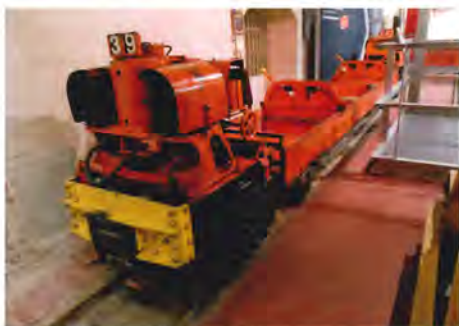
"Lokomotivet" eller motordelen på en bogie med det lille hjul under lad-delen fra en anden generations enhed, ibrugtaget 1931. Læg mærke til trækhjulets størrelse. Hele lastdelen er en enhed for sig, som kun sidder i en tap på hver bogie. Det gør service og udskiftning nemt. Rolf Brems
