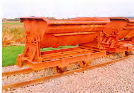
Typisk tipvogn til udbedring af sporanlægget.
