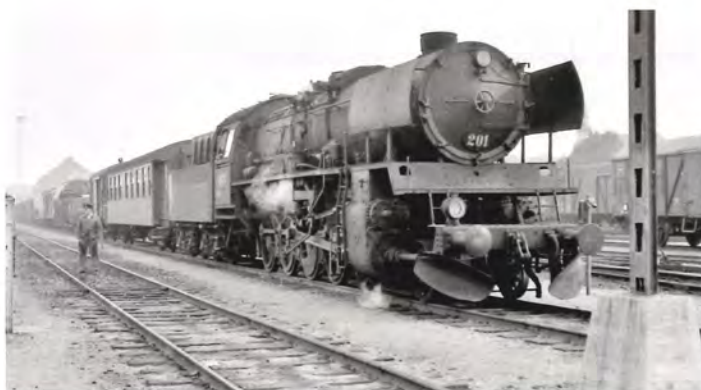
Mange af de danske ændringer kan ses her - sne- og røgskærme, 'havebænk', forlænget fodplade, røgkammerdør. N 201 i Odense, ca. 1968. Foto Kaj Pedersen.
