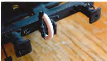
Nærbillede af pufferplanken med vacuumslange og koblingskæder.
