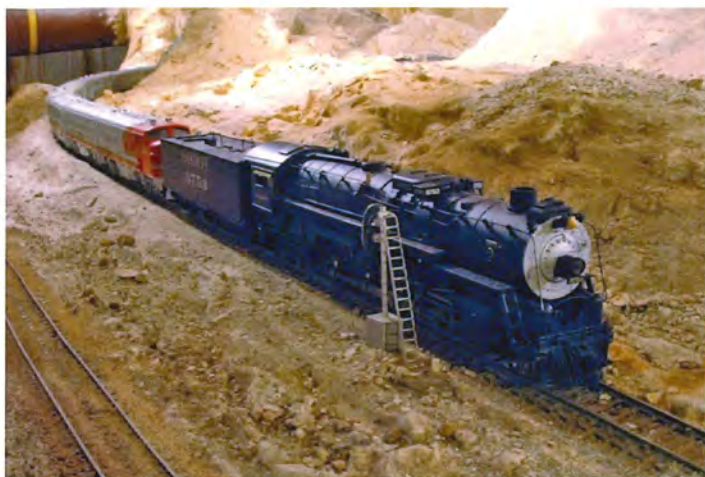
Nr 3753 fra Santa Fé er en 4-8-4-maskine, ved en anden bane kaldt Northern-typen - her foran nogle diesellokomotiver i Warbonnet-bemaling.
