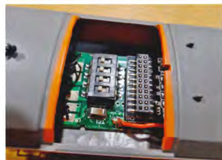
Når et stykke af taget er fjernet, kommer 'museklaveret' til syne - en fin løsning.
