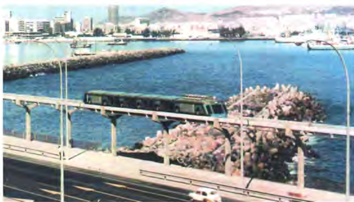
Her ses Vertebradoen på en del af den 1,5 km lange højbane. Motordelen ligger formodentlig under sektionen med køleaggregater. Foto Luis Jose Cabrera Hernández
