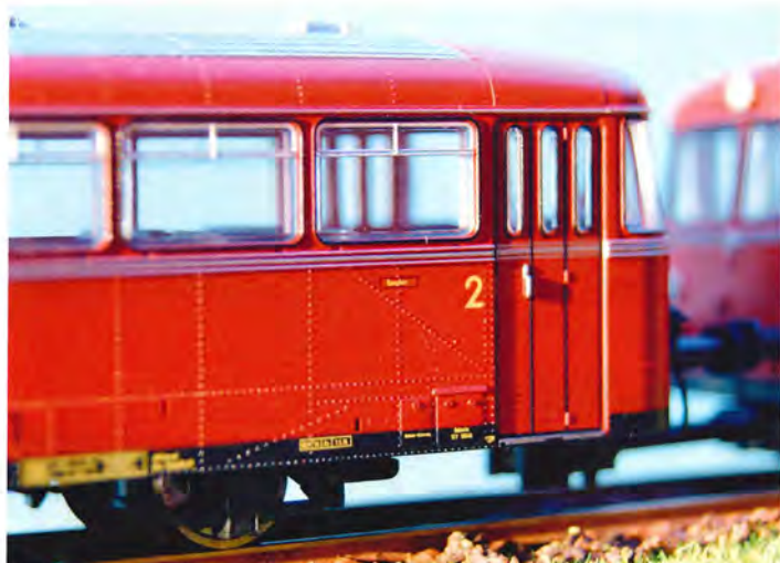
Flotte nitterækker på siderne, der viser grundkonstruktionen på skinnebussen.
