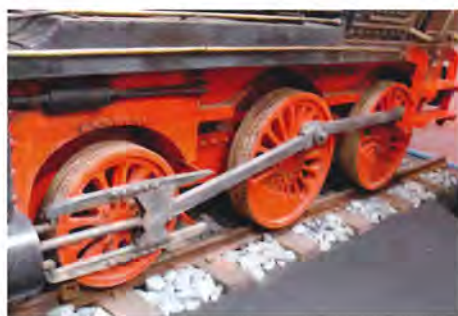
Hjulene på Jim Knopf-lokomotivet har slidbaner, men ingen flanger på hjulene.
