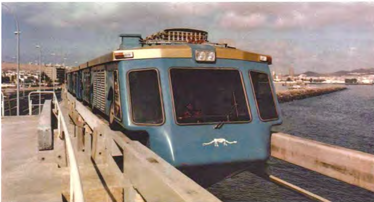
Vertebrado under prøve kørsel. Læg mærke til gummihjulene ved vinduerne. Der var endvidere tværliggende gummihjul for at kunne holde den horisontale retning i sporet – se aftegningerne på betonfundamentet. Foto Luis Jose Cabrera Hernández
