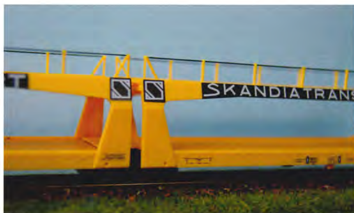
Vognen er leddelt og har et fint, spinkelt rækværk.
