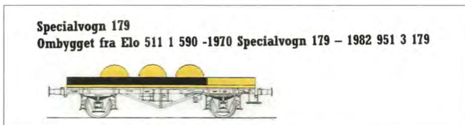
DSB Specialvogn 179, ombygget fra Elo 511 1 590. Tegning Børge Sundahl.
