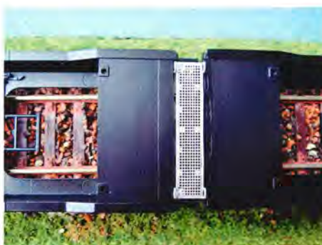
Overgangs- eller forbindelsesstykket mellem de to vognhalvdele med fint, gennemhullet trædeplade.
