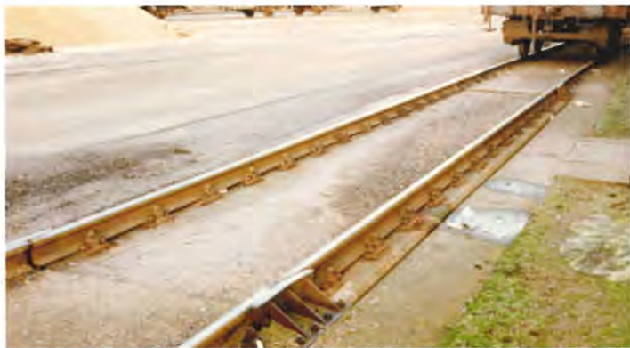
Vognvægten på Odense Godsbanegård var af typen med bevægelige, afbrudte køreskinner, som vognen stod på under vejningen. Foto Flemming Søeborg.
