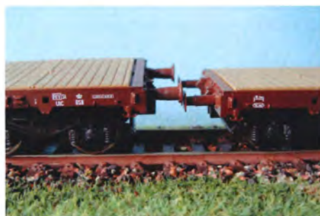
Buffere i 'Märklin-højde' til venstre og den mere normale højde på Lurpak-vognen til højre.
