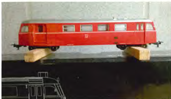
SP-vognens modsatte side som spartlet og grundmalet. Bemærk vinduesombytningen.
