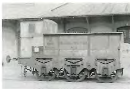
DSB Brovægtsprøvevogn nr. 8 med påbygget bremsehus. Ukendt sted og tid, slg. Sundahl.
