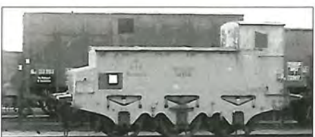
DSB Brovægtsprøvevogn Nr. 178 - endnu et eksempel på en vogn med påbygget bremsehus. Slg. Sundahl.
