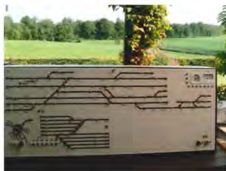
Centralapparat til Oves modelbane - alt er bygget af ham selv, og det er uden relæer, men med chips.
