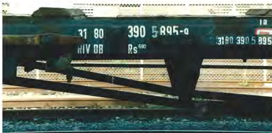
Nærbillede af en Rs 680. Man ser to opklappede læssesveller og lidt af det karakteristiske sprængværk. Vognnummeret er større end svarende til serien produceret frem til 1966. Det skyldes, at der er tale om en ombygget vogn med bedre bremses. Disse 150 ombyggede Rs-vogne hedder helt korrekt Rs 680.1. Foto fra Frederiksværk 24. maj 2006.
