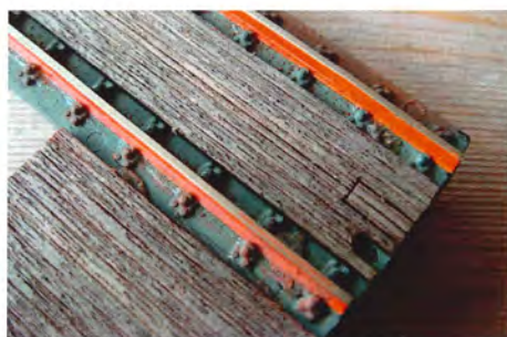
Skinner og trædæk monteret på broen. Husk at patinere skinneprofilerne, inden de monteres. I midten skal låsepallen placeres.
