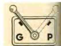
Betjeningshåndtag for G-P-omstillere til langsomt- eller hurtigtvirkende bremse.
