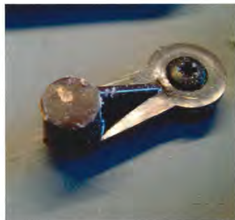
Skurken er denne føringsdums fra servomotoren – den skal files et par millimeter i højden og bredden.
