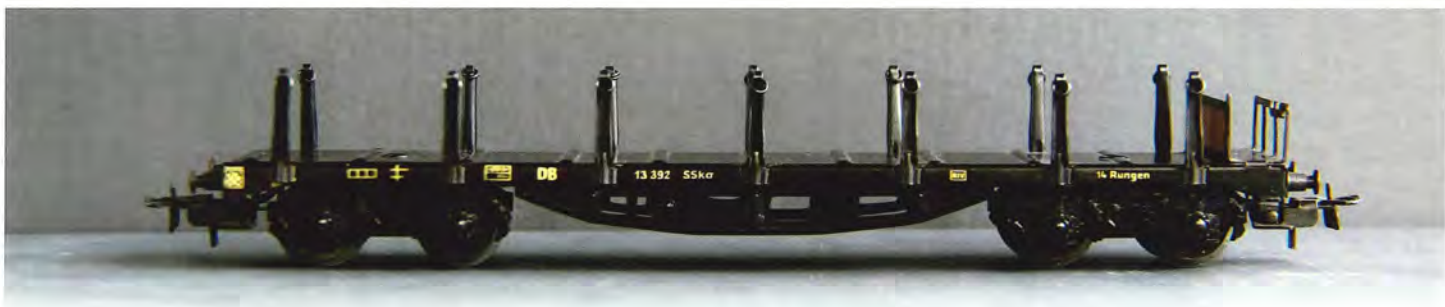
Model 392C, som den ser ud i 2017. Vognen understøttes af to langsgående såkaldte fiskebugsbjælker.
