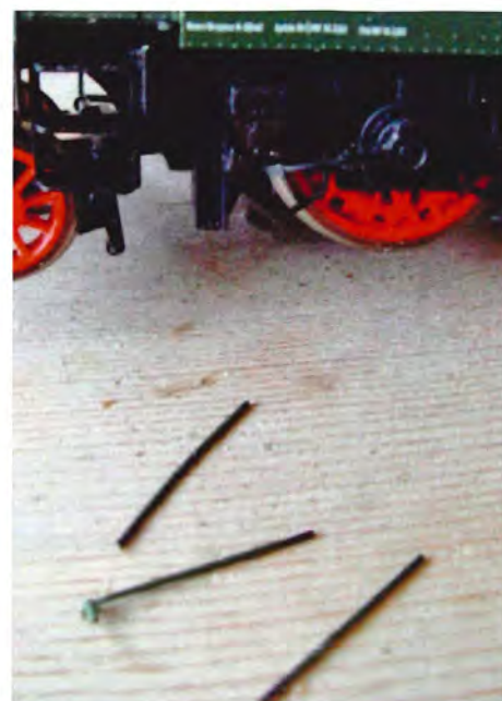
Desværre er plastmaterialet til håndbøjlerne meget skrøbeligt.
