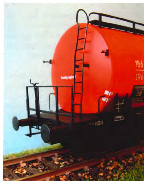
Bremseplatform med diverse detaljer.
