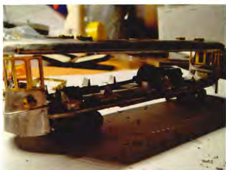
Provisorisk opstilling med fronter, tag og undervogn. Alligevel kunne prøvekørslen foretages med held.
