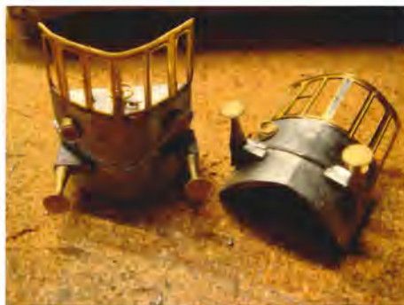
Fronterne med lanterner, buffere og førerpulte - klare til montering. Den venstre buer stadig en del, hvor den skal spidse til, men disse fronter er altafgørende for modellen.
