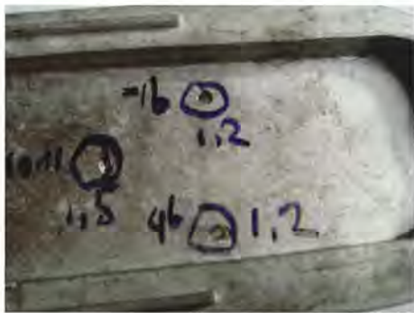
Inden boring i taget markeres hullerne med angivelse af borttykkelse.
