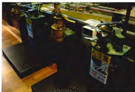
Kørekontrollere og bremsehåndtag, der kan betjenes af besøgende. Den hvide boks mellem kontrollen og bremse er møntindkast for betjening af førerpladsen. Liggende over boksen anes den kortfattede instruktion i betjening af førerpladsens håndtag. Hvor svært skal det være at køre lokomotiv?
