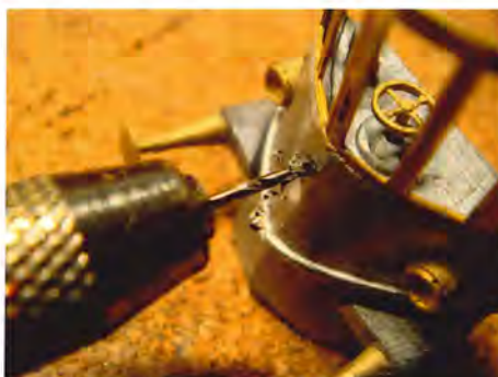
I fronterne skal der bores huller til horn og koblinger, hvilket går hurtigt.
