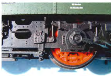
Flotte detaljer på undervognen med markering af de specielle hjulskiver.
