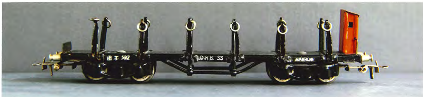
Märklins tømmervogn, som den tager sig ud i 2017. Stadig en flot og markant vogn. Bremsehuset og det relativt spinkle sprængværk er karakteristiske for denne vogn.
