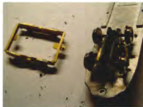
Bogierammen passer nøjagtigt til bogien, men er alligevel problematisk og endte med at blive kasseret. Tappen på rammen er til koblingskrogen - nok lidt underdimensioneret.
