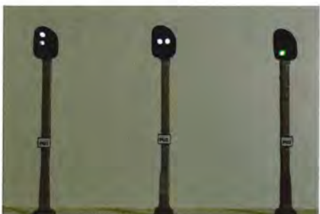
PU-signalerne viser "forbikørsel tilladt", "forbikørsel forbudt" og "kør".
