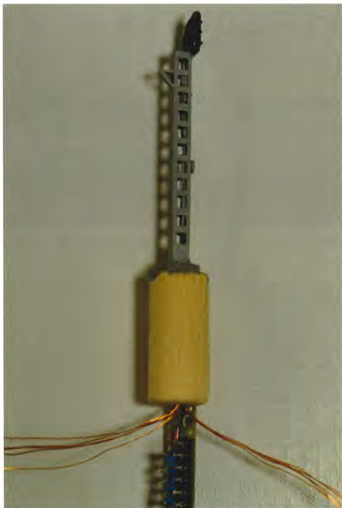
Kobbertrådene mangler her kun at blive loddet fast til printet.
