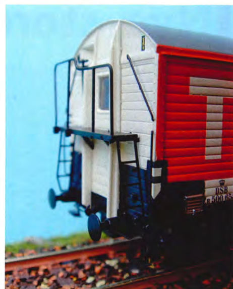
Gavlen med bremseplatform på Tuborgvognen. Foto SoB.
