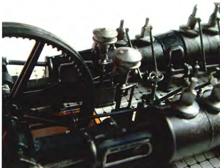
Interessante detaljer på dampmaskinen så som sikkerhedsventilerne efter Watts princip.
