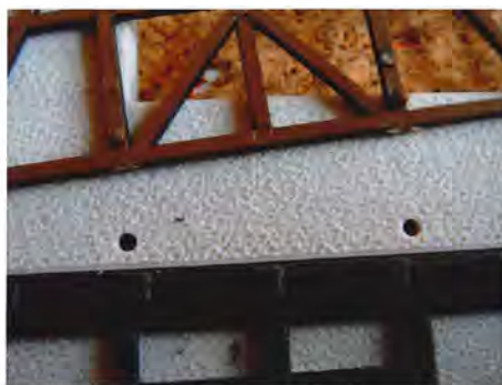
Små huller i murværket, der svarer til tappe på bindingsværksdelene, gør det nemmere at samle huset.
