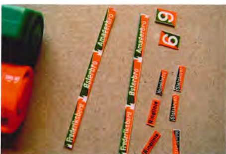
Sving-, side- og lineskilte gøres klar. De hvide snitflader farves med rød hhv. grøn speedmarker.
