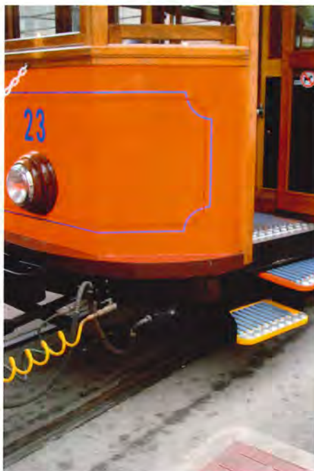
De nye, todelte trin på vogn 23 gør det lettere for passagererne ved på- og afstigning. Puerto de Sóller 24. september 2016. Foto FS.
