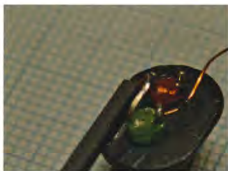
Dioderne monteres med kobbertråd. En rolig hånd og en nyspidset loddekolbe er påkrævet.
