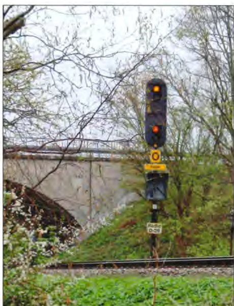
Indkørselssignalet til Køge syd fra med alskens 'pynt', den 28. april 2015. Foto SoB.
