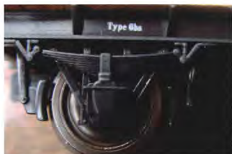
Detalje af akselgaffel m.v. på IM-vognen.
