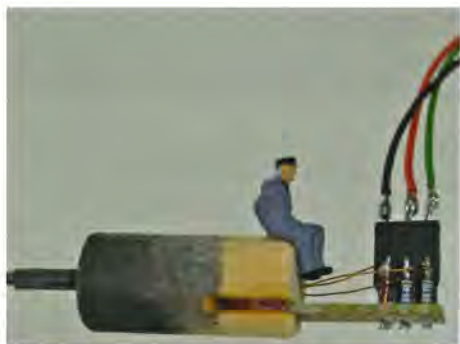
Hulprint monteret med stik, ensretter, modstande og kobbertråd.
