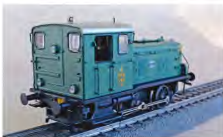
Bagenden på Ardel'ten med typiske detaljer og den pudsige, stærkt svungne plade til trinene.
