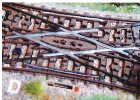
Englænder med indlæg af stanniol til forbedring af strømoftag. Der er også strimler ilagt ved tvangsskinnerne.
