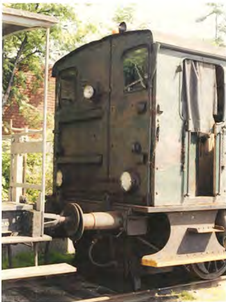
Bagvæggen af Ardelt 111 med lygteplacering, den pudsige trinholder m.v. Helgoland 1986. Foto Vagn Holstein.
