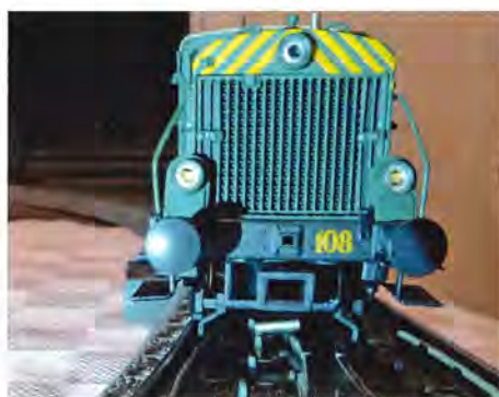
Her ses det tydeligt, at slæbeskoen kan komme til at kortslutte på mellemstrengen eller støde på punktkontakten.
