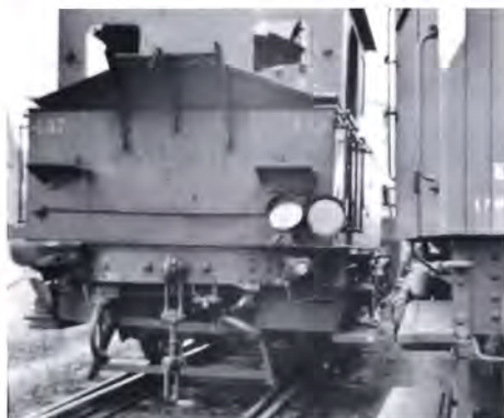
F 457 efter et kraftigt sammenstød i Næstved 1962 - blandt andet er begge kurvpuffere revet af. Hjelpevognen t.h. synes at være en gammel MT.
