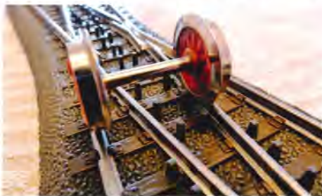
Som det kan ses, er der risiko for kortslutning mellem hjul og punktcontakter ved mellemstrengen på krydssporet.
