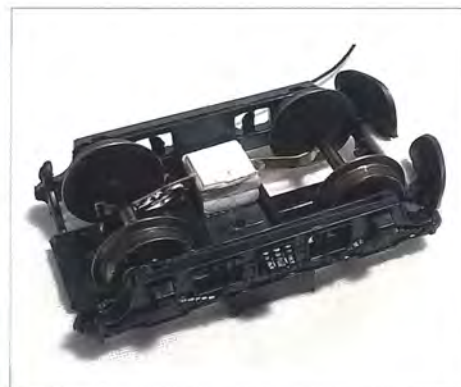
Den oprindelige PIKO-boggie genanvendes i fronten af styrevognen, dog her med strømoftag i den ene side og banerømmere monteret.
