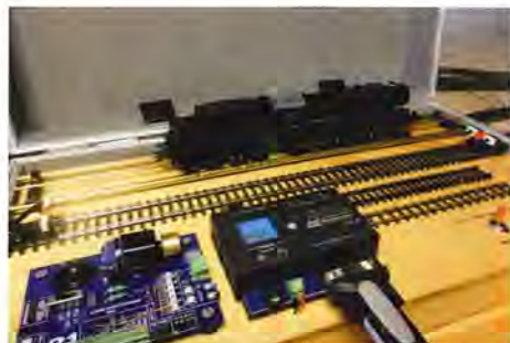
Her er det en N-maskine der er på rulleprøvestanden. Læg mærke til ESUs prøvebænk til venstre med højttaler og motor, til højre er ESUs lokprogrammer, SPROG'en ligger gemt under pladen sammen med strømforsyningen.
