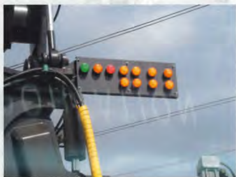
Lyspanelet på løfteåget, lamperne viser parvis fra højre, når åget er i den rigtige position. Når benene klemmer, lyser to mere, de næste fire lyser, når man kan løfte. Den røde indikerer fejl og låser åget, så skal der en aktiv handling til for at komme videre. Den grønne viser klart for løft af container.
