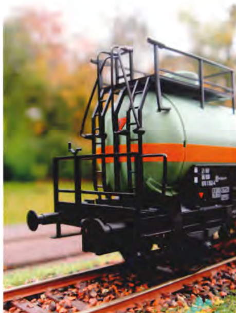
Klortankvognens bremseplatform med flere lejdere og håndbøjler - samt en halvgemt advarselstrekant
