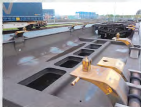
Låsetappene på en lommevogn, så den også kan bære en container.
