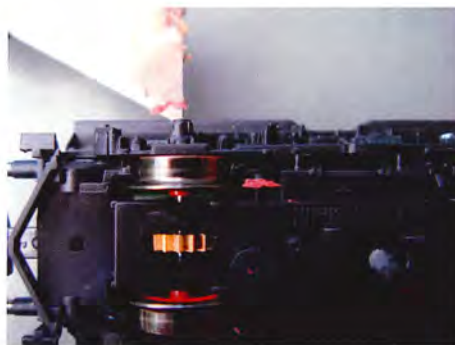
Fodpladerne på Fleischmann-undervognen rager for langt ud og skal skæres 1-2 mm tilbage
