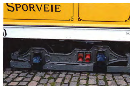
Maximum Traction-bogien med de to typer af hjul - det store styrehjul forrest til højre med drivhjulet bagest
