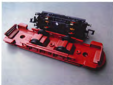
Før ombygningen bliver akselafstanden kontrolleret
