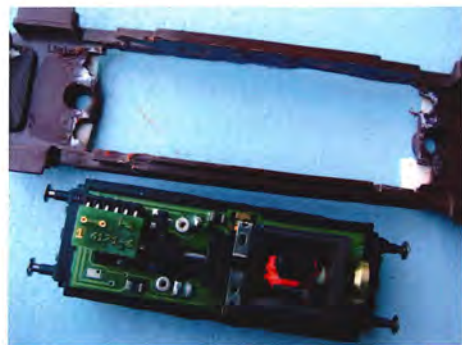
Der er fræset ud til bufferne og limet små stykker plast ovenpå for at holde undervognen på plads
