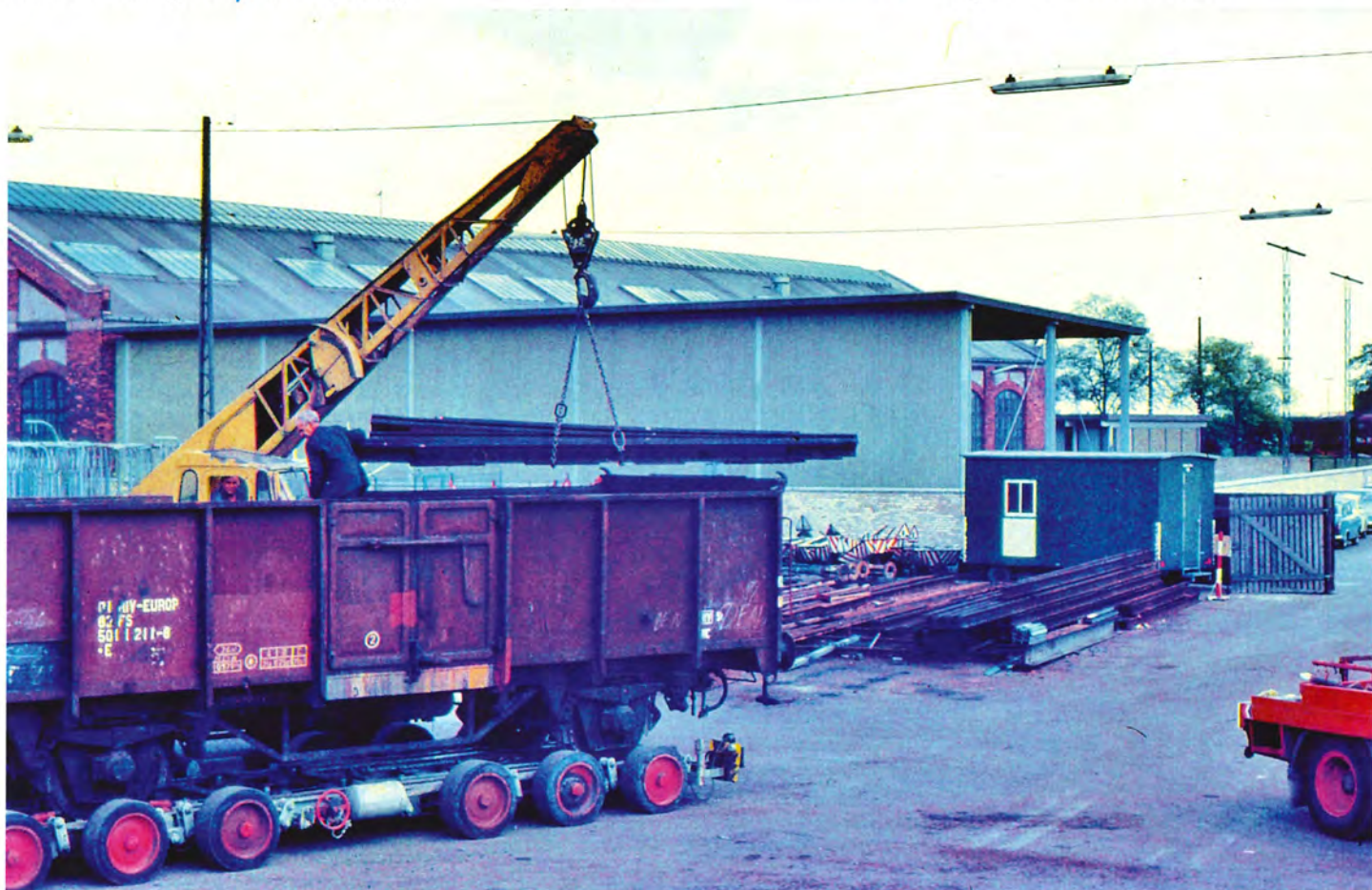
FS-godsvogn litra E på vognbjørn under oprydning med COLES-kran på Enghave Remise omkring 1970. Foto Leif Bang
