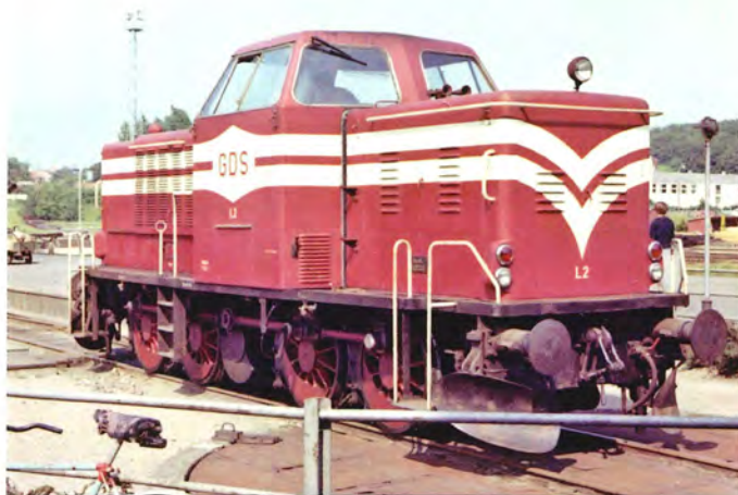
Gribskovbanens MaK-lokomotiv L 2 måtte ud på en lille drejeskive, for at man kunne skifte spor, for ellers kunne det ikke komme uden om sit tog.
