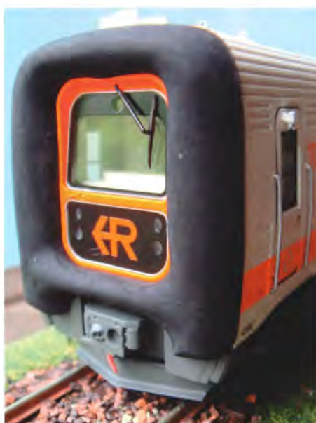
Gumminæsen er perfekt gengivet i en art gummimateriale. Vinduesviskerne er monteret på forhånd.
