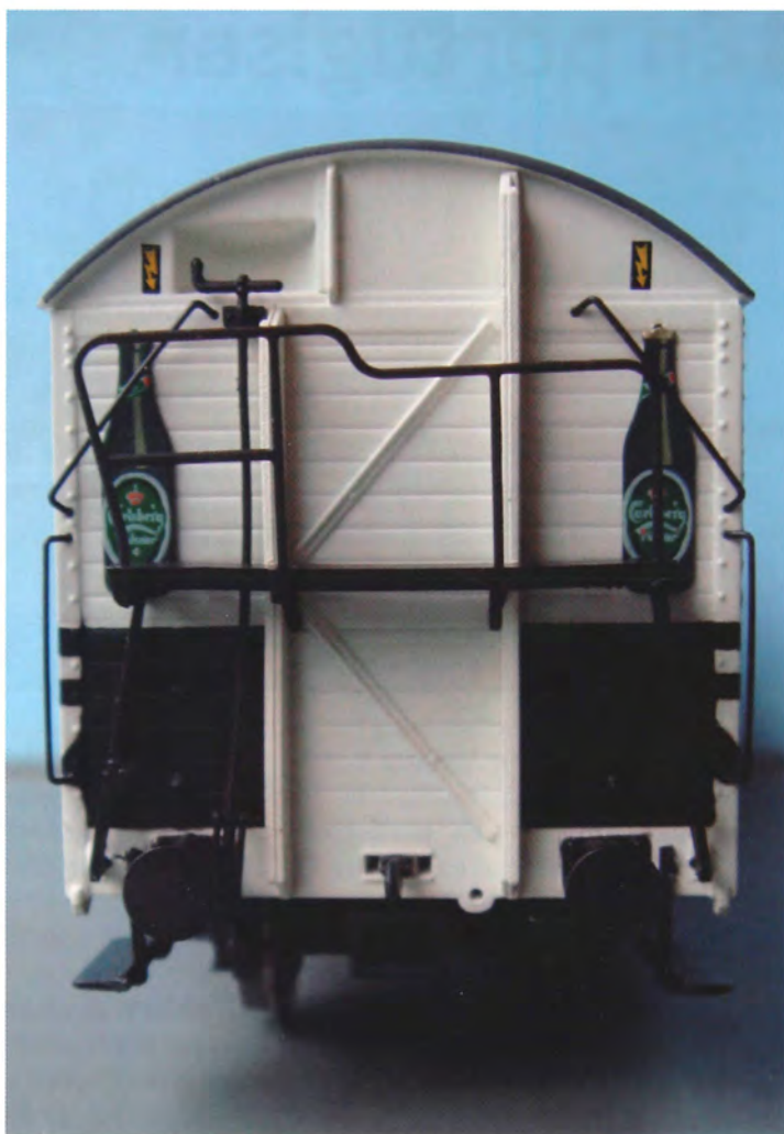
Gavlenderne på ølvognen med med farvestrålende og inspirerende reklameskilte. Hullet er til en bremseslange.
