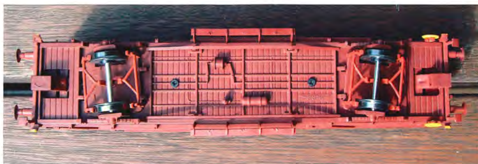
Undervogn med (teorerisk) radialt indstillelige akselholdere.
