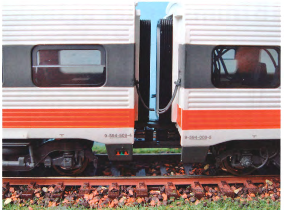
Kabler er også med på de to vogndele. bemærk også det frie gennemsyn gennem vinduerne. Desværre slutter gummivulsterne ikke tæt sammen. Bemærk de flerfarvede påtryk.
