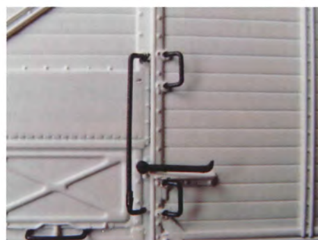
Nærbillede af låsetøj, håndgreb m.v. på I-vognen.
