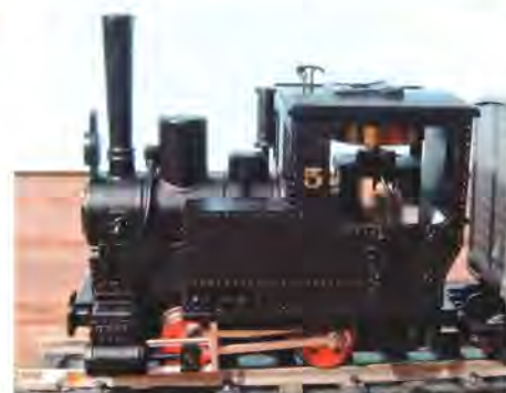
Krauss-lokomotivet med rigtigt stort svinghjul i førerhuset - det hjælper betydeligt på køreegenskaberne.
