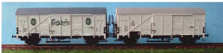
Hs og I - vel nogle af de sidste, rent danske godsvognskonstruktioner. De senere H-typer baserede sig f.eks. på tyske forbilleder.
