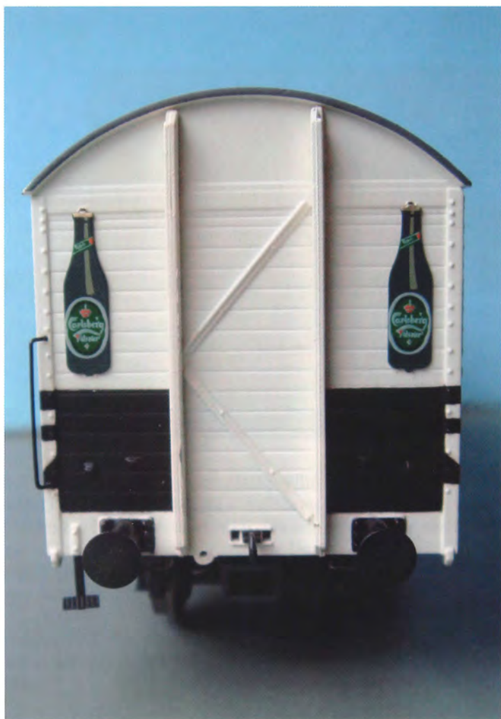
Gavlenderne på ølvognen med med farvestrålende og inspirerende reklameskilte. Hullet er til en bremseslange.
