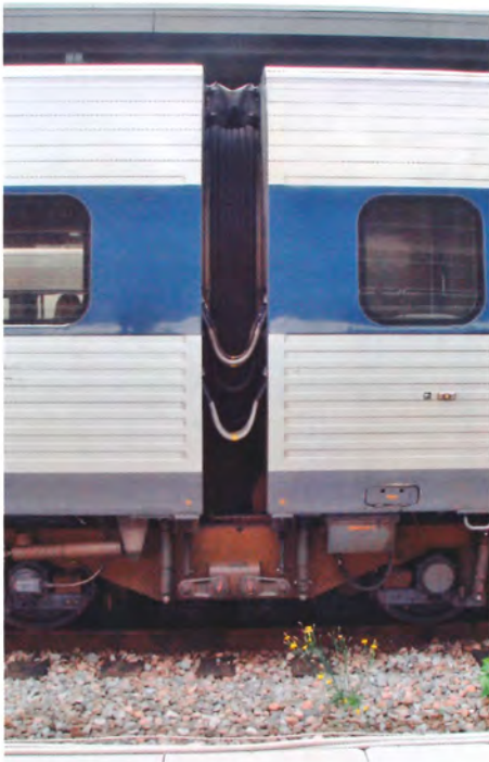
Kabler mellem to IC3-moduler og helt lukket overgang. Odense, den 2. juli 2016. Foto SoB
