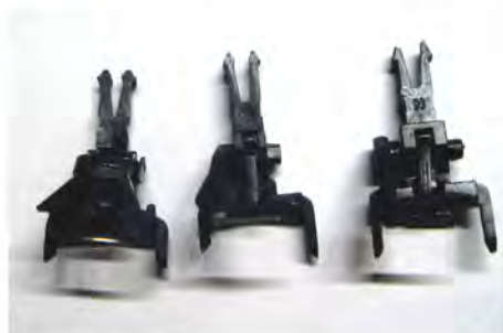
Tre typer kortkoblinger - fra venstre mod højre Märklin, Roco, ESU.
