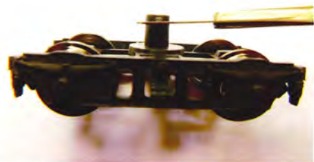
Den lille grat, der skal fjernes fra bogien. Foto Vagn Holstein
