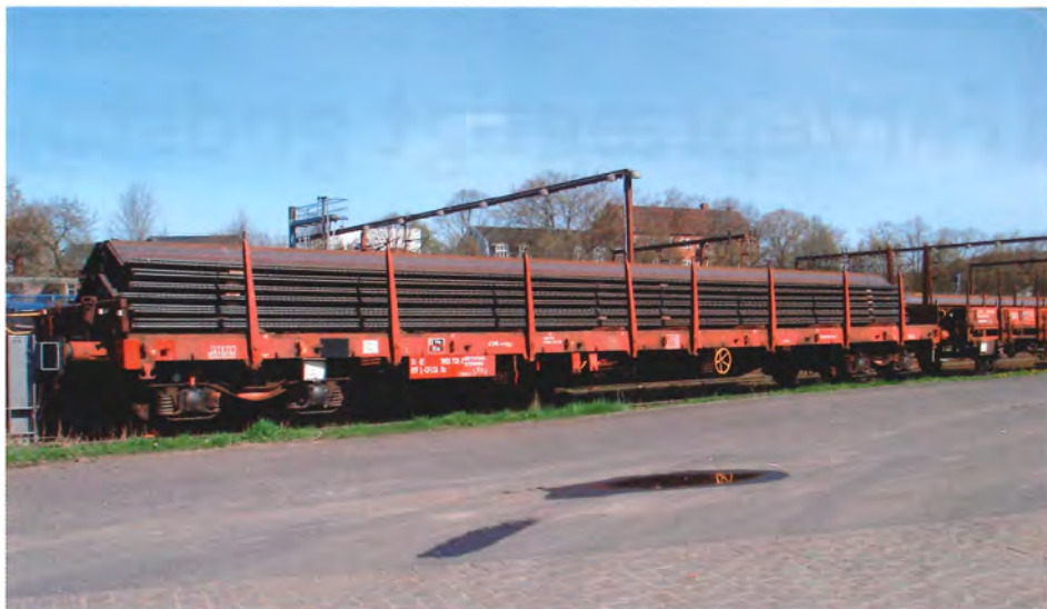
CFL Rs-vogn 31 82 3905 732-2 tungt læsset med spunsvæg-elementer på læssevejen.
