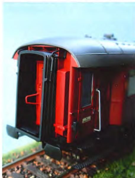
Den anden gavl har blandt andet et skab monteret over det ene vindue (til forråd eller kul).
