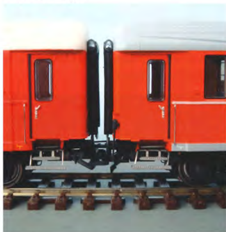
Märklin- og Roco-kortkoblinger giver også kort koblingsafstand
