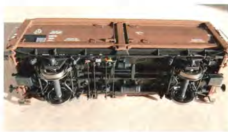
McK-vogn set nedefra. Læg mærke til de små tandhjul bag bremseomstilleren.
