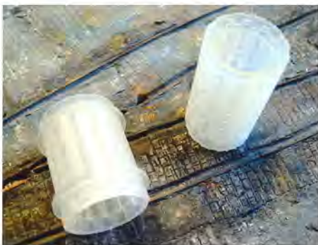
De to valser med hvert deres præg - den lille til venstre med randene til udformning af rillesporet.
