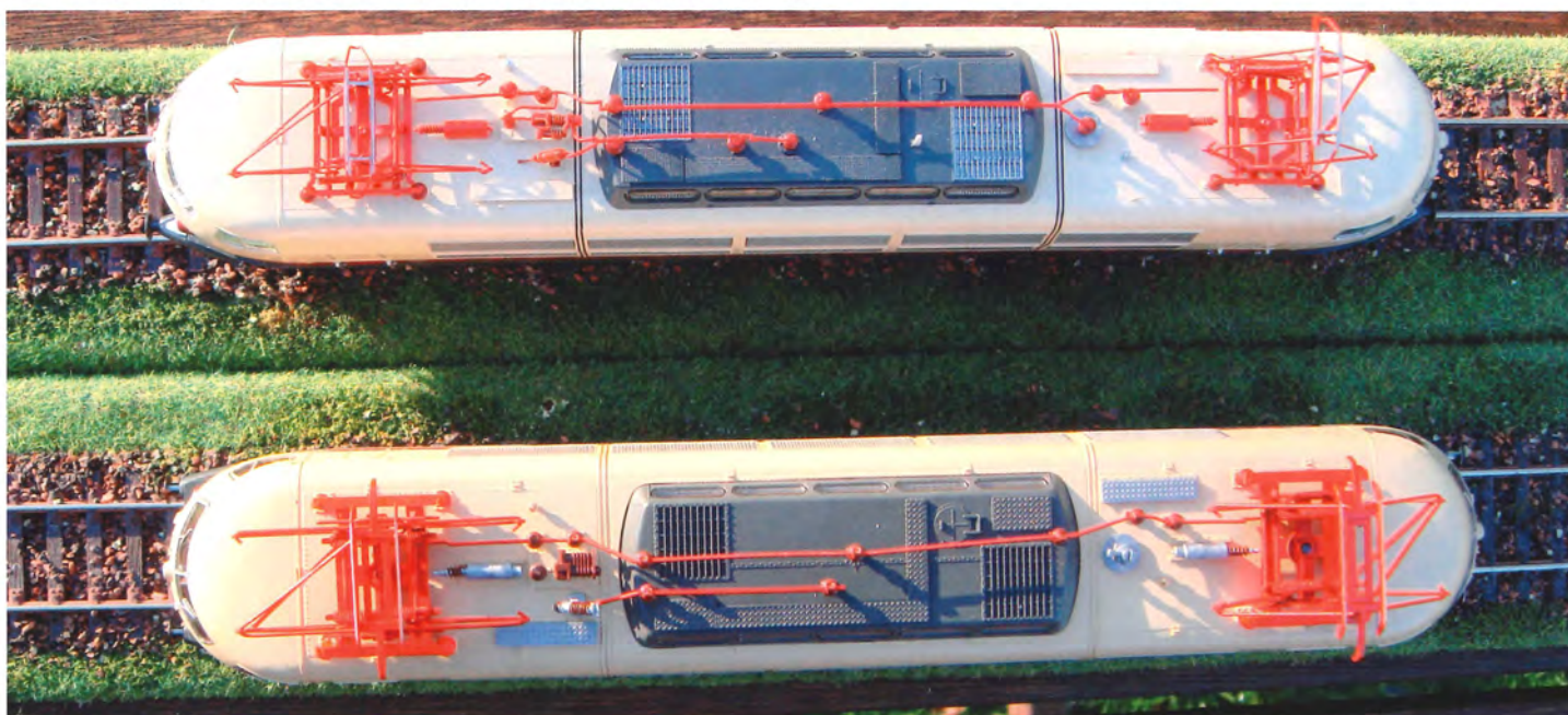
Set oppefra er den mest iøjnefaldende forskel pantografernes størrelse, men der er også mindre forskelle på tagdetaljerne
