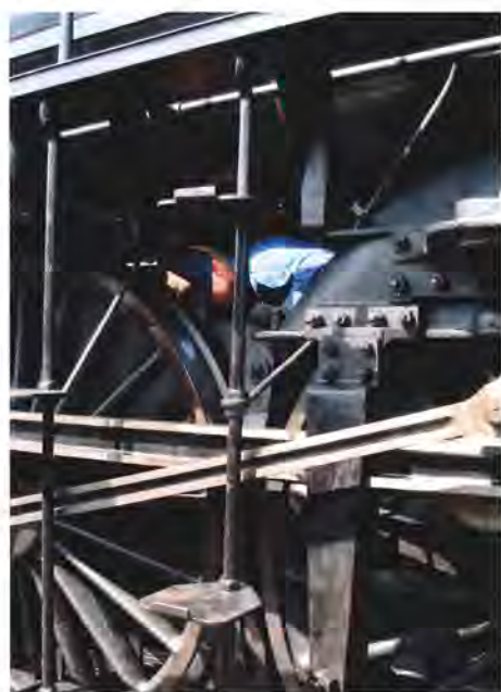
Opsmøring af E 991 Randers 2009 - man skal ikke lide af klaustrofobi eller lignende ved det arbejde. Foto Flemming Søeborg
