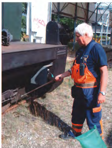
Naturligvis skal bremserne lige afprøves inden kørslen - det sker med den lange hammer
