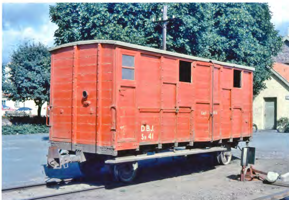
En af godsvognene blev ombygget til skinnebus-bagagevogn DBJ Sb 41. Her ses den i Nexø 1963. Foto Leif Bang
