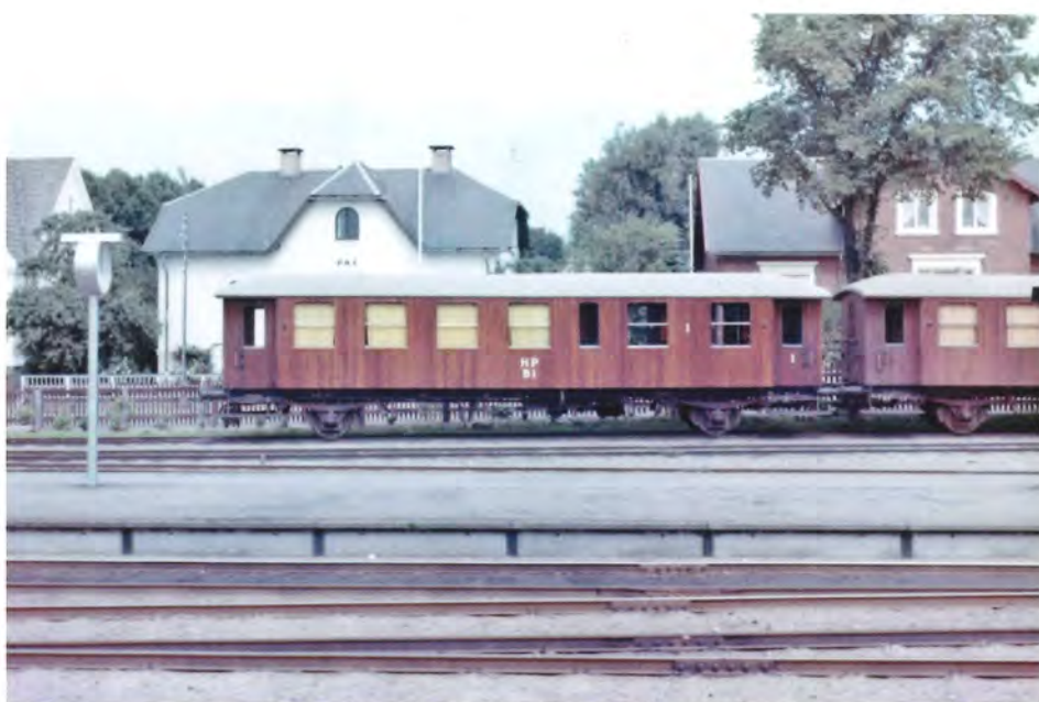
HP B 1 var den ene af to flotte kombinerede 1. og 2. classes personvogne bygget 1925. Det ser lidt ejendommeligt ud med det smalle vindue i midten. De gule gardiner på 2. klasse liver gevaldigt op.
