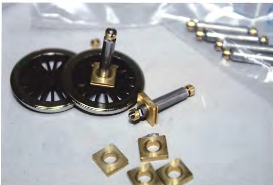
Markit hjul og hornblokke, beregnet til forbedring af UK Modellers C-maskine. Foto Niels Gerlev Jensen
