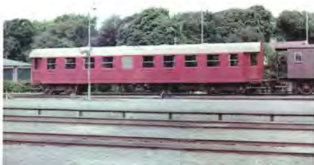
D 63 var en kombineret person-, post- og rejsegodsvogn. Dørene var placeret i indhak, og typen var ikke så almindelig. At man betegner vognen med et D, tyder på, at den ikke længere blev brugt til persontransport.
