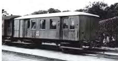
D 63 var en kombineret person-, post- og rejsegodsvogn. Dørene var placeret i indhak, og typen var ikke så almindelig. At man betegner vognen med et D, tyder på, at den ikke længere blev brugt til persontransport.
