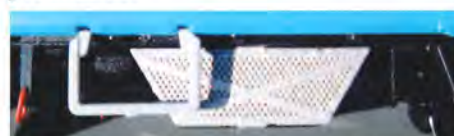
Afdækning af kompressor på undervognen
