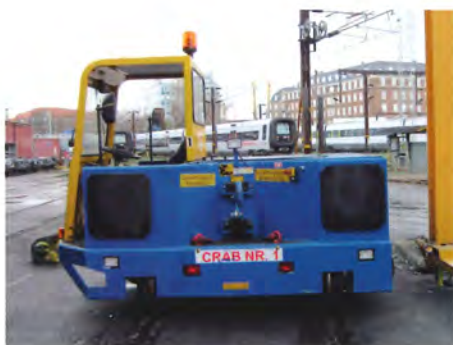
CRAB'en på besøg på Helgoland ved Svanemøllen i 2011. Gummibelægningen på skinnehjulenes køreflader kan anes
