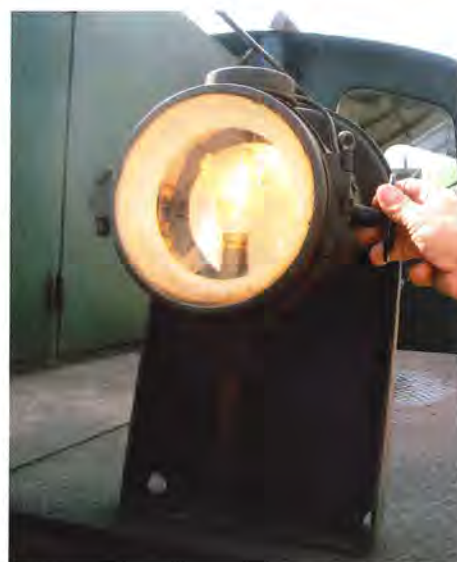
Lysskift på Køf'en sker med en vippeanordning...
