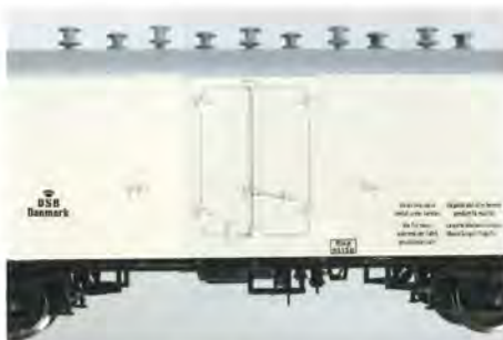
Nærbillede af siden med de mange påskifter samt bremsepåskriften og rækken af rotoror på taget. Foto hobby trade
