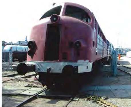
Her er man i gang med at lave en klassisk Märklin-front med stor spalte til koblingen på en MY. Arkiv Spor og baner
