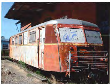
Fra et af de tidlige forsøg på at udskifte glasklare vinduer med matgrå cellonrunder i en dansk skinnebus. Skælskør 22. april 2009. Arkiv spor og baner
